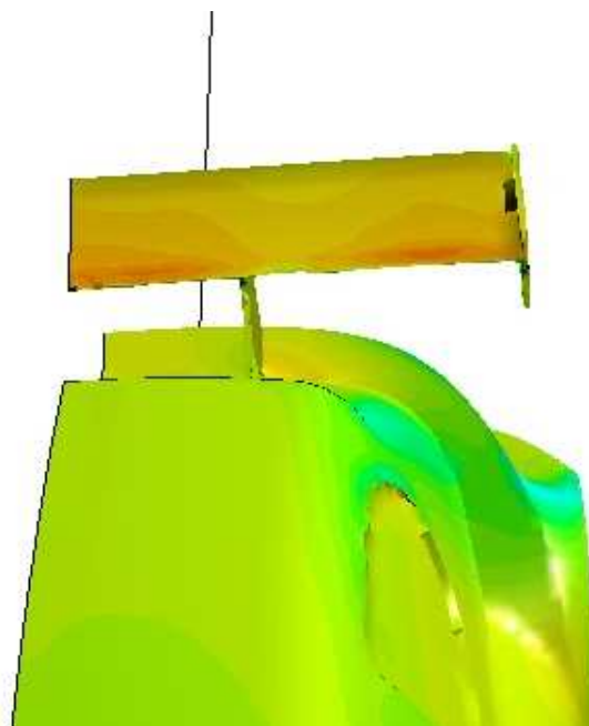
Mapa de presiones en la superficie del alerón
