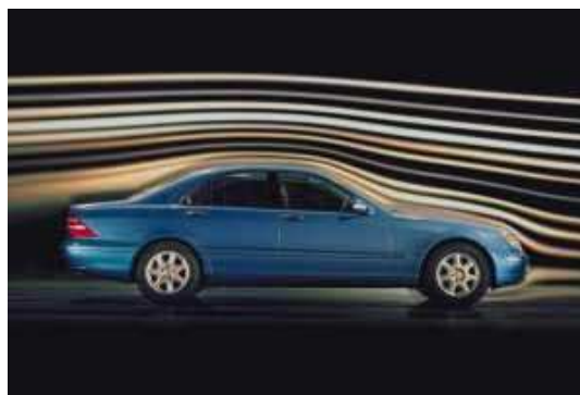
Trayectorias de humo, túnel del viento
