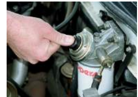
Diesel primer pump
