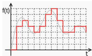
Ilustração 16: Representação de uma onda sonora (a cinzento representação analógica e vermelho a digital)
