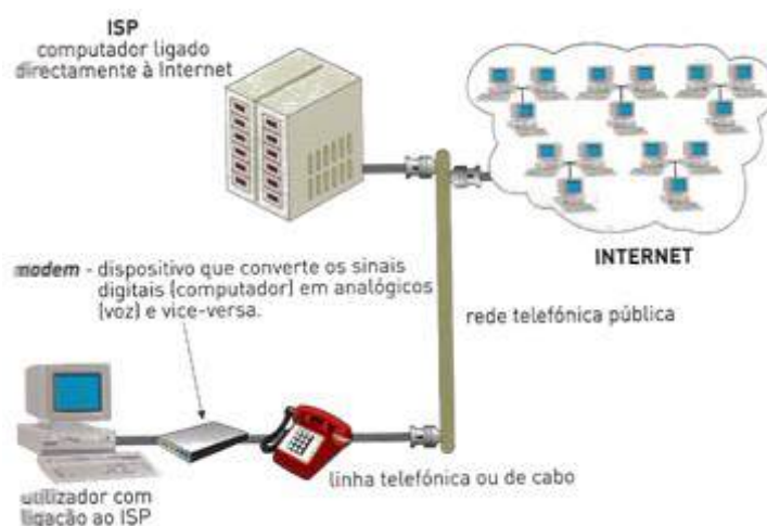
Ilustração 43: Esquema simplificado de ligação à Internet
