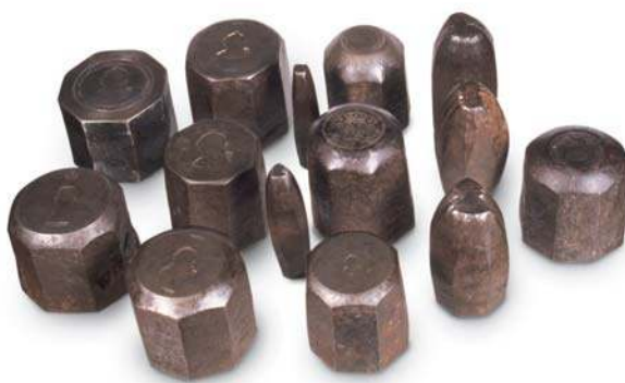
Fig. 228. Instrumentos de acuñación de monedas y medallas: cuños, matrices, punzones. Reinados de Carlos III, Carlos IV y Fernando VII (1759-1833). Acero.
