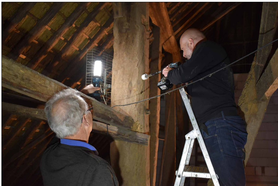
Afbeelding 57. Sjoerd van Daalen neemt een boormonster uit een van de stijlen, eigenaar Arjan Klaver schijnt bij.
