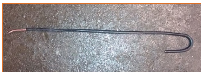
Figura 1 – ferramenta rudimentar para retirada do cavaco
