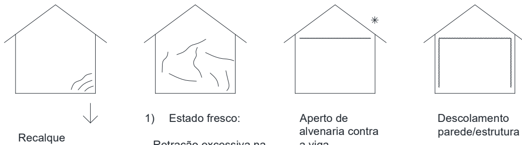
Figura 95 – Casos comuns de fissuras em alvenaria e revestimento.
