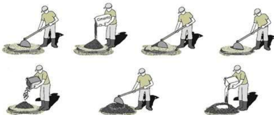
Figura 31 – Mistura manual de concreto.
