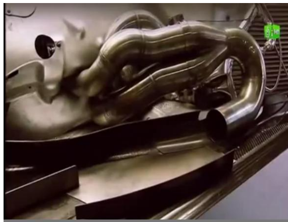
Ilustración 7.7: Soplador de aire hacia el difusor [30]
