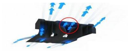
Ilustración 7.2: Salida del aire del difusor [29]
