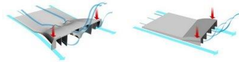
Ilustración 7.3: Líneas de corriente en el doble difusor [29]
