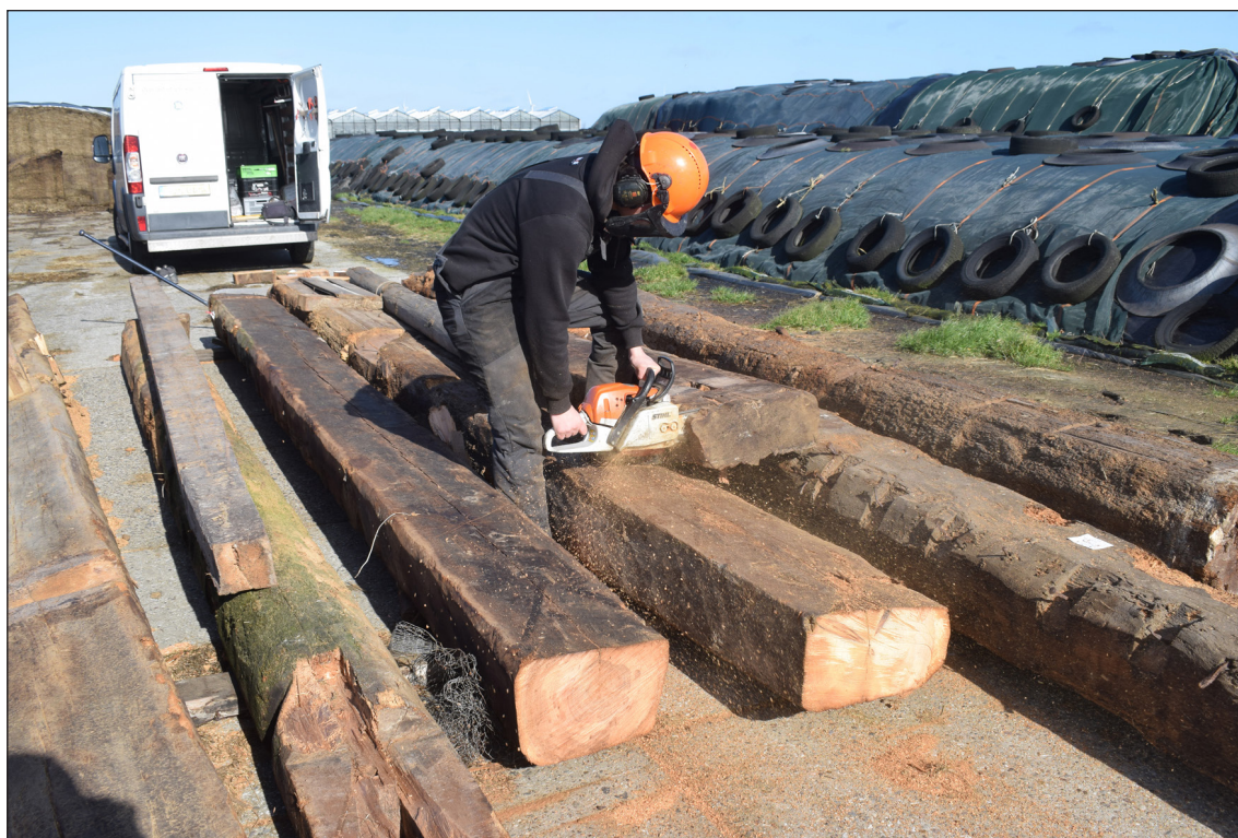
Afbeelding 78. Na de sloop zijn uit de balken van het vierkant houtmonsters gezaagd.
