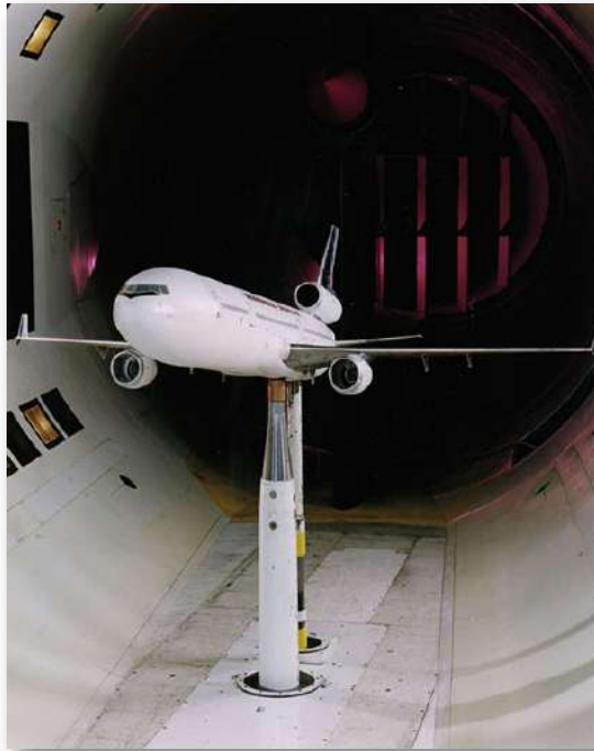
Figura 6.30. Los investigadores de la NASA prueban un avión modelo en un túnel de viento (crédito: NASA / Ames)
