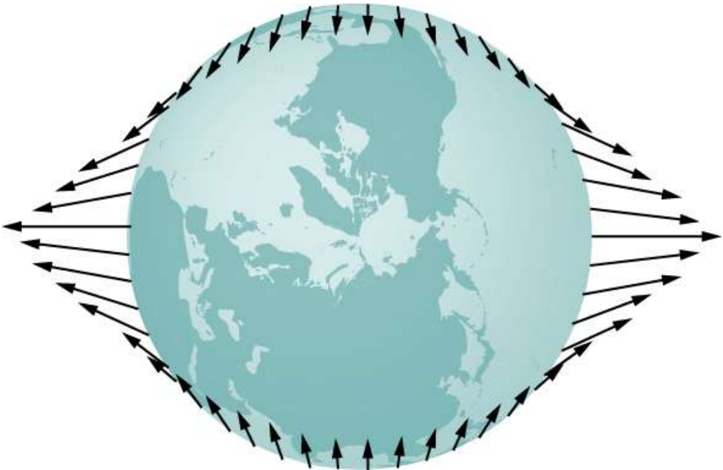
Figura 10.23. La fuerza de marea es la diferencia entre la fuerza gravitatoria en el centro y la que está en otro lugar. En esta figura, las fuerzas de marea se muestran en la superficie del océano. Estas fuerzas disminuirían a cero a medida que te acercas al centro de la Tierra.
