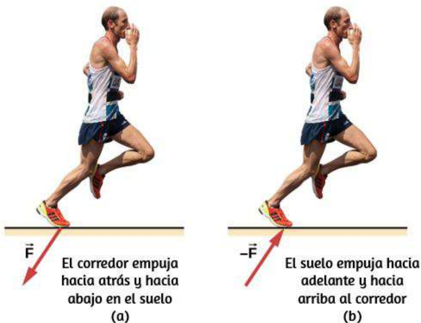
Figura 5.19. El corredor experimenta la tercera ley de Newton. (a) Una fuerza es ejercida por el corredor en el suelo. (b) La fuerza de reacción del suelo sobre el corredor lo empuja hacia adelante.
