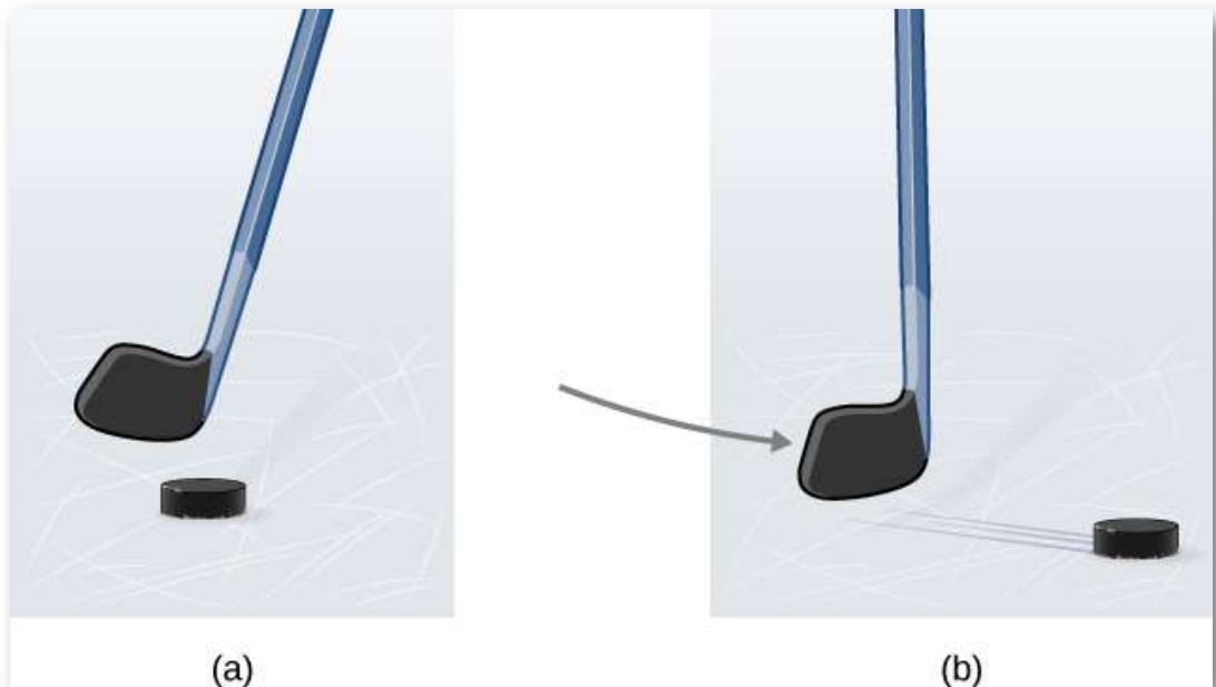
Figura 5.7. (a) Se muestra un disco de hockey en reposo; permanece en reposo hasta que una fuerza externa como un palo de hockey cambia su estado de reposo; (b) un disco de hockey se muestra en movimiento; continúa en movimiento en línea recta hasta que una fuerza externa hace que cambie su estado de movimiento. Aunque es resbaladizo, una superficie de hielo proporciona cierta fricción que ralentiza el disco.
