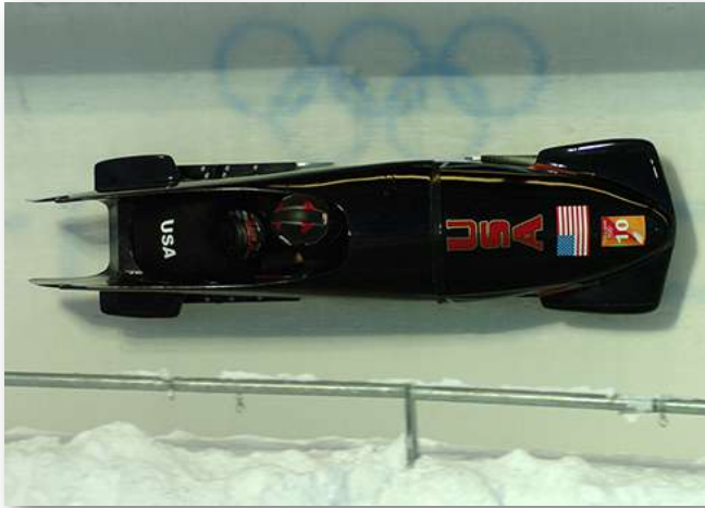
Figura 6.29. Desde coches de carreras hasta corredores de bobsled, la conformación aerodinámica es crucial para alcanzar velocidades máximas. Los bobsleds están diseñados para la velocidad y tienen forma de bala con aletas cónicas (crédito: "Ejército de EE. UU." / Wikimedia Commons)
