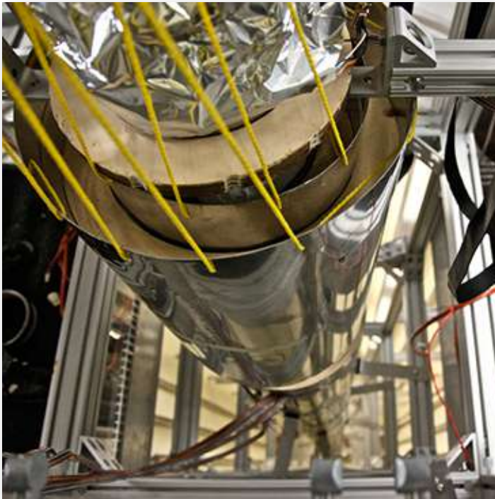
Figura 1.8. Un reloj atómico como este, utiliza las vibraciones de los átomos de cesio para mantener el tiempo con una precisión superior a un microsegundo por año. La unidad de tiempo fundamental, el segundo, se basa en dichos relojes. Esta imagen mira hacia abajo desde la parte superior de una fuente atómica de casi 30 pies de altura. (crédito: Steve Jurvetson).
