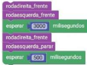
Figura 32 – Fazendo o carrinho andar para frente por 3 segundos, virar para esquerda e continuar andando para frente
