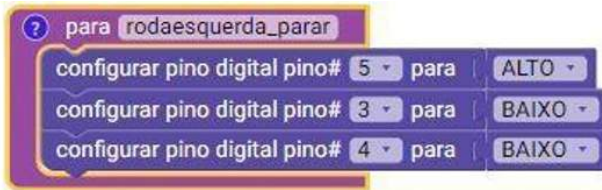
Figura 29 – Diagrama da roda esquerda: parar
