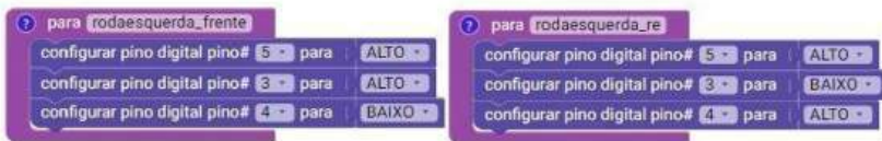
Figura 28 – Diagrama da roda esquerda: ré e frente
