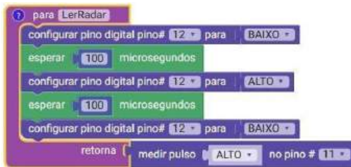
Figura 35 – Função para ler o Sensor de distância
