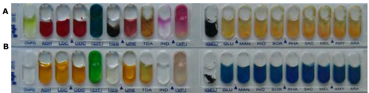
Figura 7.1. API20E. a) todos los resultados positivos. B) todos los resultados negativos ( http://www.tgw1916.net/Tests/api.html )
