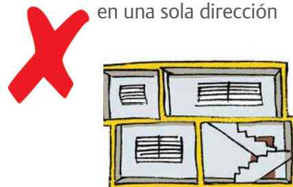
Muros sin cotinuidad
