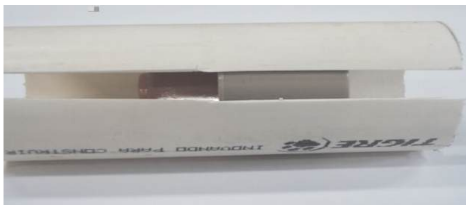
Foto 2. Mostra o monóculo inserido na bucha de redução e esta dentro do tubo H. Do lado esquerdo da figura pode-se ver a distância entre a ocular do monóculo e a extremidade esquerda do tubo H.
