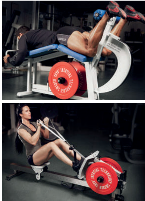
Figura 34. Yo-Yo Inercial, tipo de dispositivo para ejercicio Inercial.
