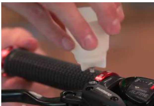
Colocar Depósito Llenado
