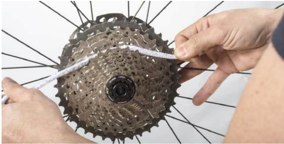
Limpiar a Fondo Piñones y Núcleo Para un Correcto Funcionamiento.
