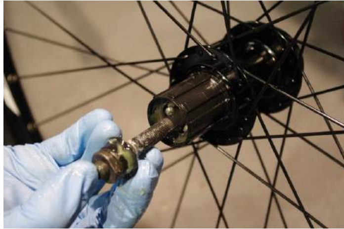
Desinstalación de la Tuerca Cónica del Núcleo.
