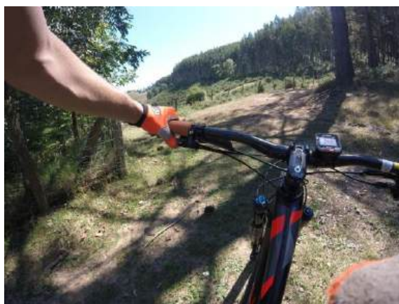
Mando Único Para Horquilla y Amortiguador, con dos Posiciones, Bloqueo (Bicicleta Rígida) y Desbloqueo (Suspensión Activa)
