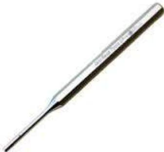
**Punta de trazar.** Esta herramienta se utiliza básicamente para el trazado y marcado de líneas de referencias, tales como ejes de simetría, centros de taladros, o excesos de material en las piezas que hay que mecanizar, porque deja una huella imborrable durante el proceso de mecanizado.
