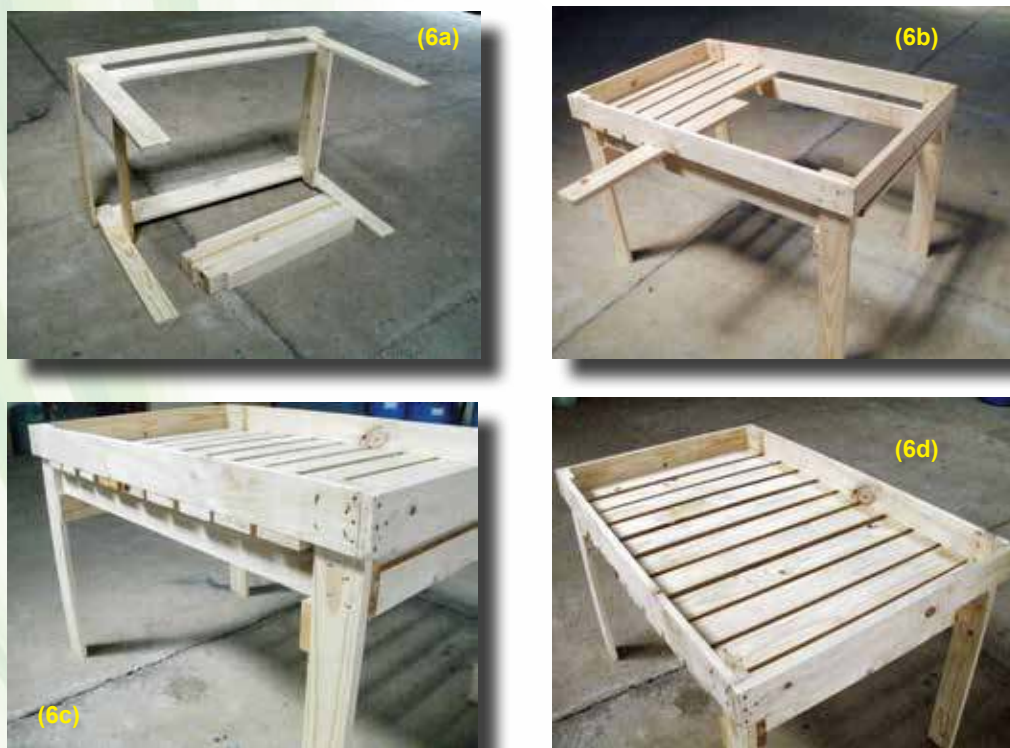
Foto 6. Colocación de las piezas para el piso de la cama de cultivo.
