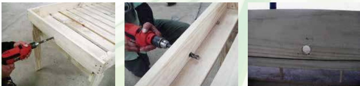
Foto 9. Perforación del orificio de drenaje en la madera de una cama de cultivo.
