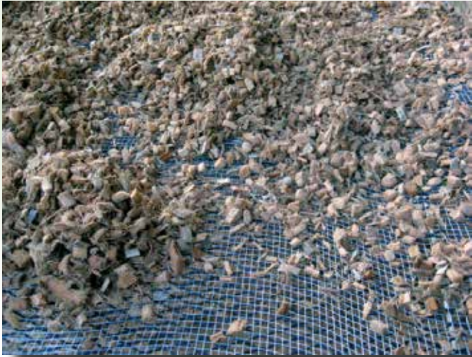
Foto 15. Separación del exceso de polvo fino en sustrato de fibra de coco mediante una zaranda.
