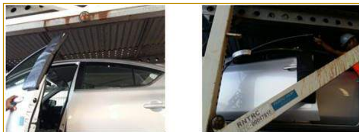
Figura 11: Testes com almofadas contragolpes
