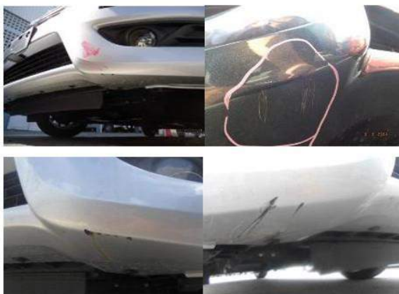
Figura 3: Exemplos de avarias do quadrante 7 e 9 do para-choque dianteiro
