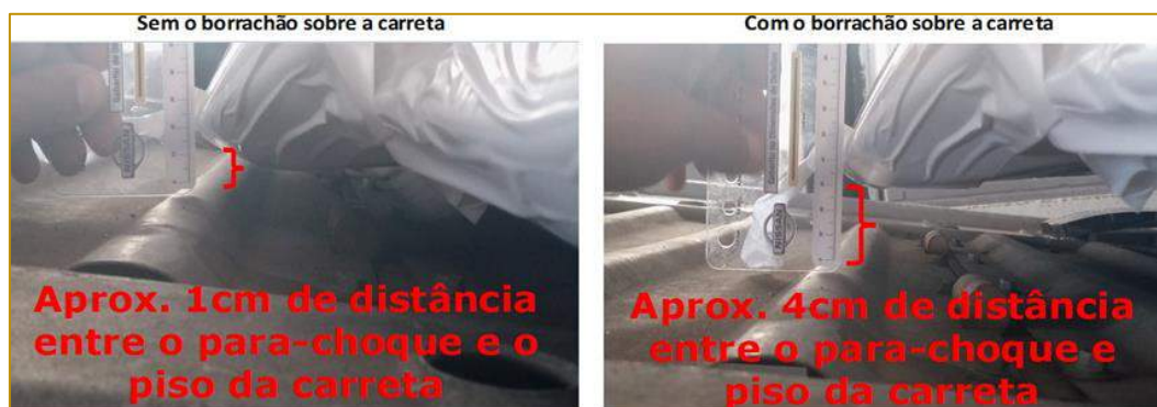
Figura 8: Comparação da distância entre o para-choque e o piso da carreta com ou sem borrachão
