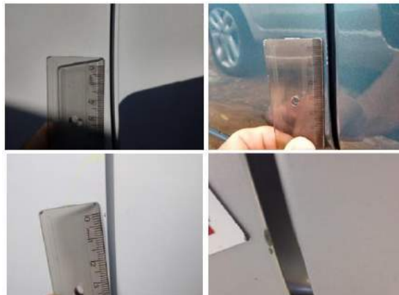
Figura 5: Exemplos de avarias do quadrante 3, 6 e 9 da porta dianteira esquerda
