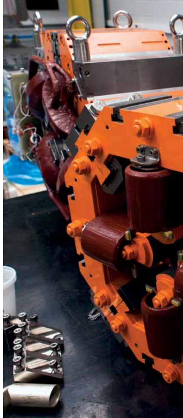
Eletroímãs durante testes de caracterização magnética na fonte de luz síncrotron Sirius
