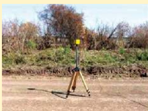
● Sonda usada por el Laboratorio Ambulante de Mediciones de Campos Electromagnéticos y Ruido, de la Universidad Tecnológica Nacional de Santa Fe, para medir la radiointerferencia de la línea de transmisión de energía eléctrica de Paraná, de 132 kV.
