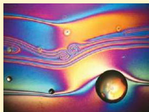
● Cristal líquido, arte fotográfico de Karen Neill. El gel se orientó con electricidad; después se interrumpió la alimentación, y se desplazaron los vidrios que encierran el gel, para peinar las moléculas en diferentes direcciones. El empleo de luz polarizada muestra la orientación de las moléculas; iguales en las regiones del mismo color. Los círculos son burbujas de aire.
