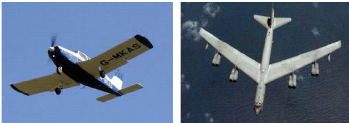
Figura 2.24 – Exemplos de asas com baixo e alto alongamento.
