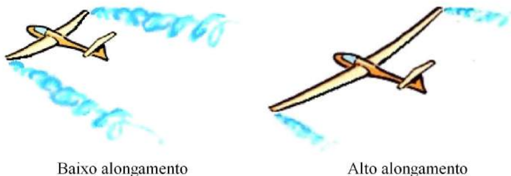
Figura 2.46 – variação do arrasto induzido devido à influência do alongamento da asa.
