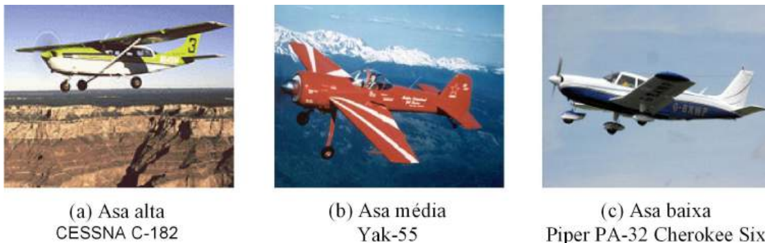
Figura 2.22 – Fixação da asa na fuselagem.
