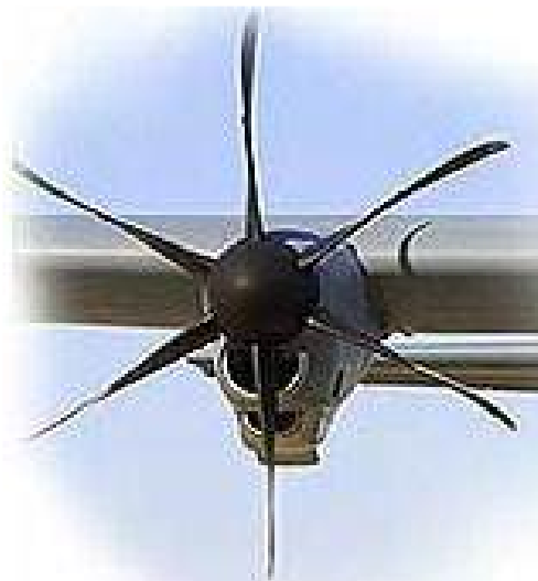
Figura 3.6 – Hélice de passo controlável.
