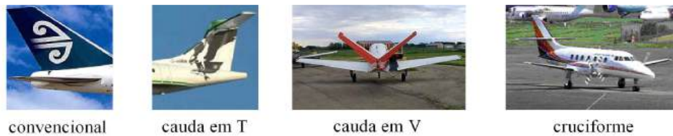
Figura 2.48 – Principais tipos de empenagens.
