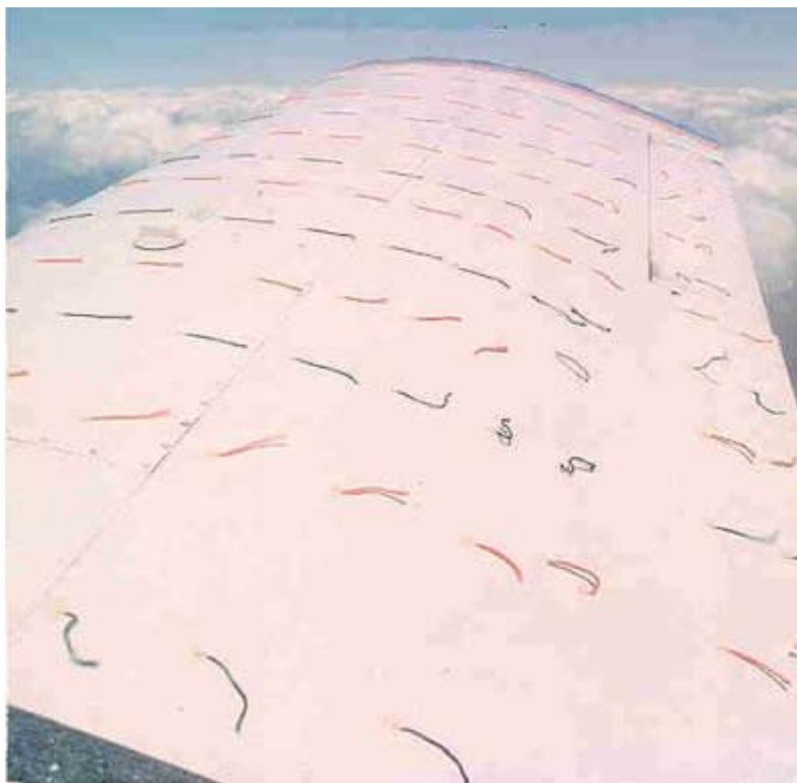
Figura 2.35 – Ensaio em voo para verificação do estol.
