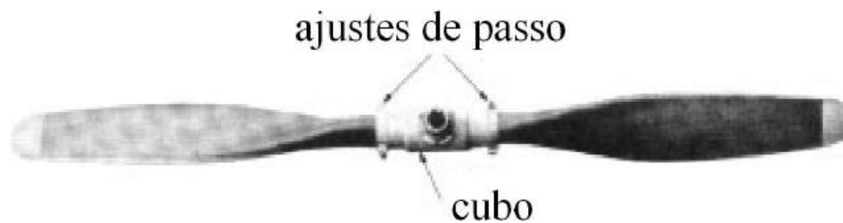
Figura 3.5 – Hélice de passo ajustável.
