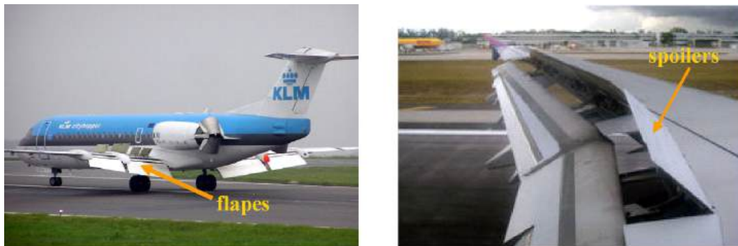
Figura 4.32 – Aplicação de flapes e spoilers.
