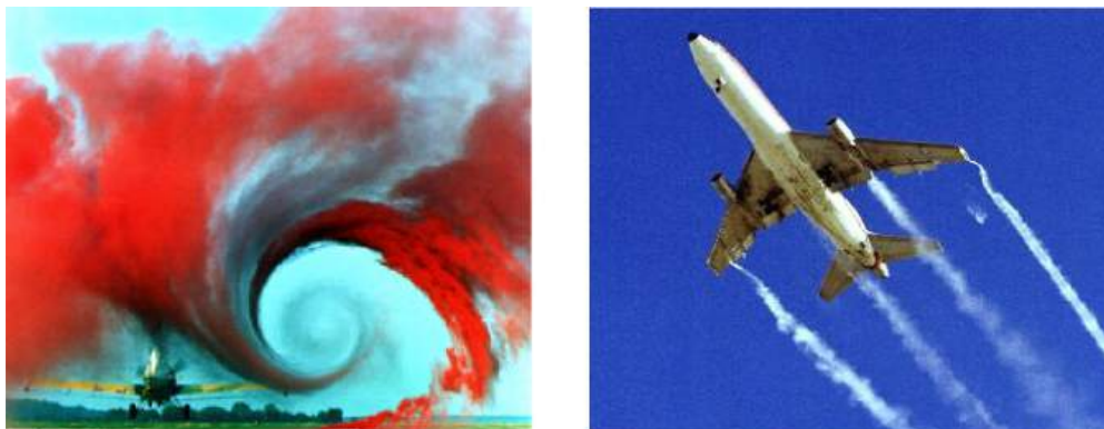
Figura 2.45 – Exemplo de vórtices gerados na ponta das asas.
