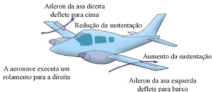
Figura 1.15 – Exemplo de funcionamento dos ailerons.
