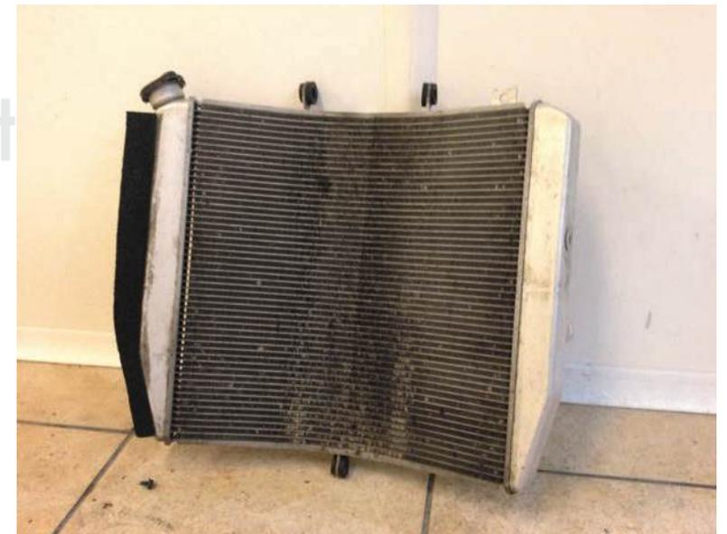
Radiador con suciedad. Externamente puede limpiarse con desengrasante, esponja y agua. No utilizar agua a presión ni frotar con excesiva fuerza.
