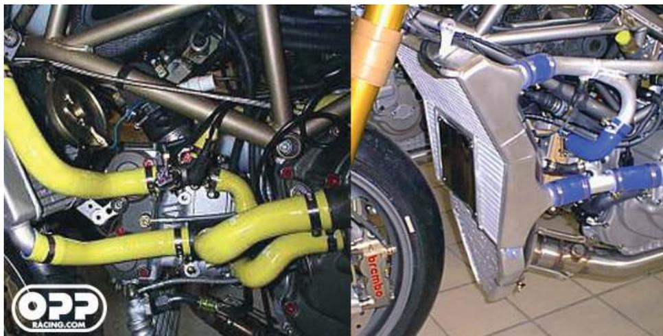
Conductos de silicona (Samco). Alargan la vida útil de los conductos y le dan un toque muy racing a tu moto.
