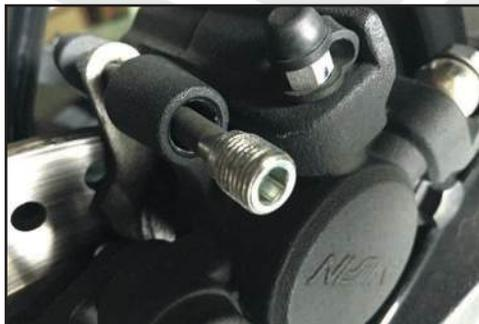
Detalle de un pasador de pastilla de freno roscado. Es un buen hábito aplicar un poco de grasa de cobre antigripante (1100 °C) para evitar que queden soldados a las pinzas y ocurra un drama en el siguiente cambio de pastillas.
