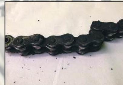
Detalle de una cadena gripada. En estas condiciones la mejor solución es sustituirla.
