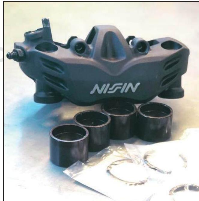
Kit de reparación de una pinza de freno Nissin. Observa el recubrimiento que tienen los pistones para reducir la fricción. Si observas desgastes en su perímetro exterior o rayadas sustituye el pistón.
