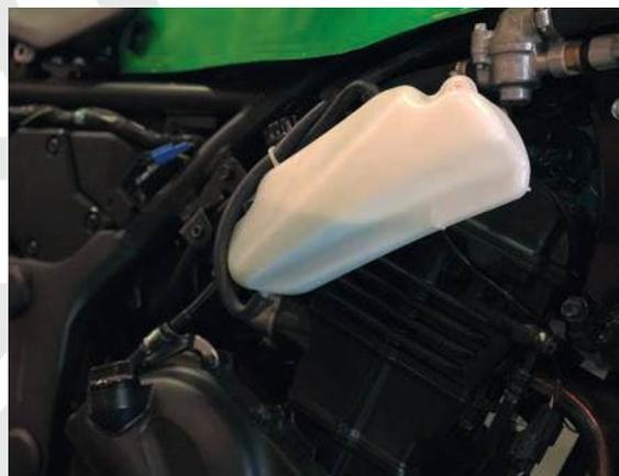
Nivel del refrigerante en el vaso de expansión. No siempre los fabricantes lo colocan en un sitio accesible y puede necesitar el desmontaje de varias piezas para rellenarlo.
