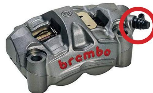
Localización del purgador de aire en una pinza Brembo.
