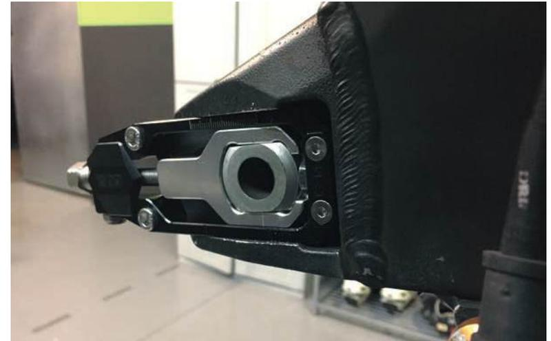
Tensor de cadena de la industria auxiliar. Facilitan tanto el ajuste de la tensión de la cadena como la instalación de la rueda.
