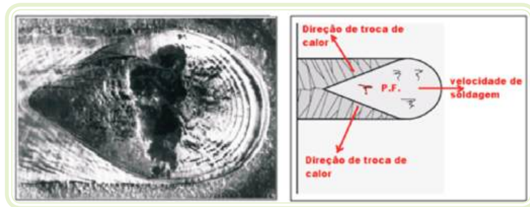
Figura 8.16: Poça de fusão em formato de gota alongada
