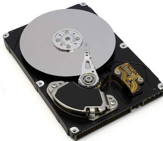
FIGURA 12.28 El interior de un disco duro. El disco plateado contiene la información, mientras que el fino lápiz óptico situado en la parte superior del disco lee y escribe información en este.
