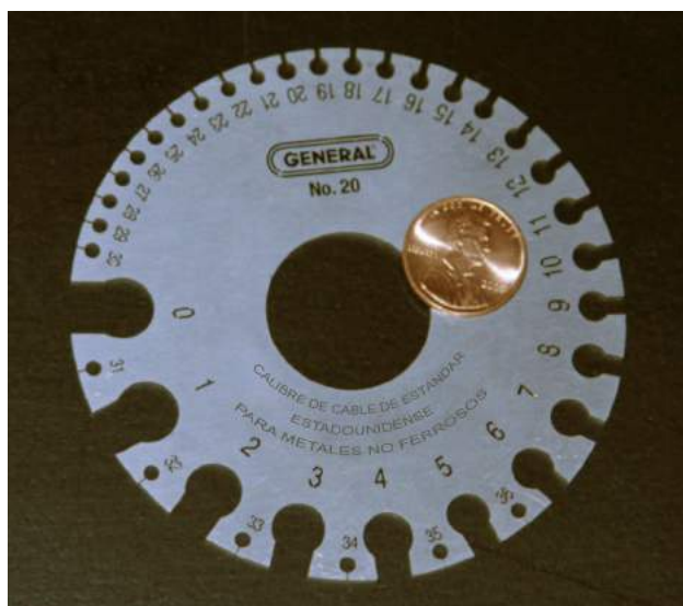
FIGURA 9.11 Dispositivo para medir el calibre de los cables eléctricos. Como puede ver, los números de mayor calibre indican cables más finos (créditos: Joseph J. Trout).
