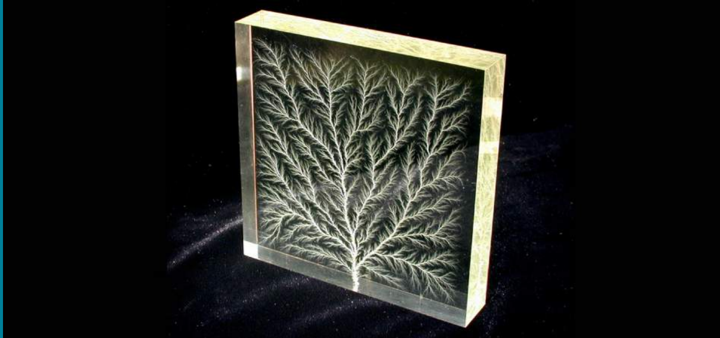
Figura 8.1 Los patrones de ramas en forma de árbol de este bloque de Plexiglas® transparente se conocen como figura de Lichtenberg, que recibe su nombre del físico alemán Georg Christof Lichtenberg (1742-1799), que fue el primero en estudiar estos patrones. Las "ramas" se crean por la ruptura dieléctrica producida por un fuerte campo eléctrico (créditos: modificación del trabajo de Bert Hickman).
