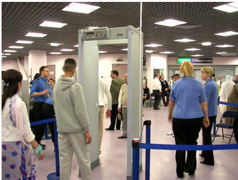
FIGURA 14.9 La conocida puerta de seguridad de un aeropuerto no solo detecta los metales, sino que también puede indicar su altura aproximada sobre el suelo (créditos: "Alexbuids"/Wikimedia Commons).
