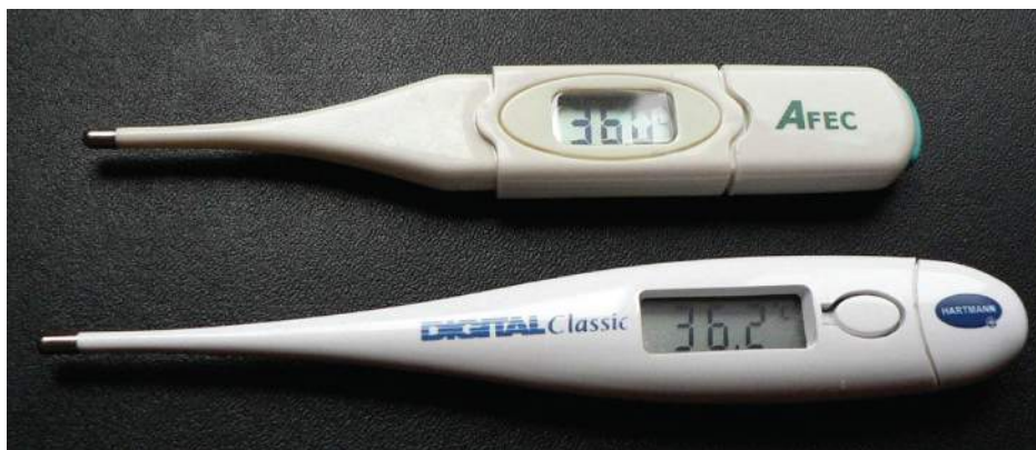
FIGURA 9.17 Estos conocidos termómetros se basan en la medición automatizada de la resistencia dependiente de la temperatura de un termistor.
