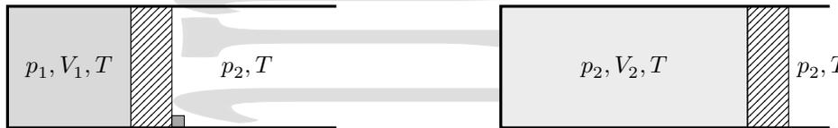
Figura 4-5: Expansión monoterma contra una presión exterior  $p_2$  constante.
