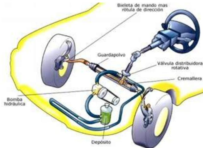
La misión de la dirección es la de orientar las ruedas delanteras para dirigir el vehículo a voluntad del conductor y con el menor esfuerzo. Para no tener que hacer grandes esfuerzos. Además de la reducción conseguida en la caja de engranajes, cada día se utiliza más la dirección asistida.
