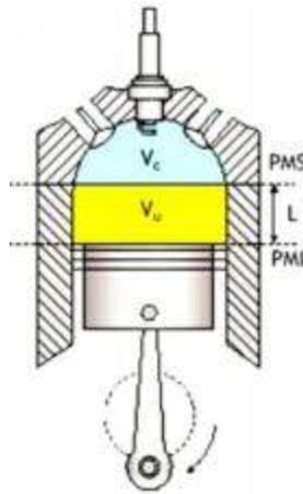
La relación de compresión en los motores de explosión suele ser entre 7-11 a 1, y en los diesel de 18-24 a 1 aproximadamente, siendo el doble en algunos motores diesel con respecto a los de explosión.
