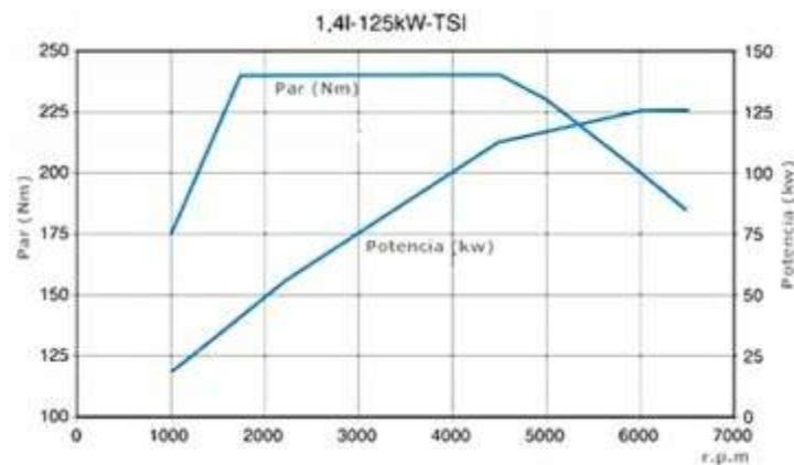
En la figura se representa la curva de potencia y la del par motor en función de las revoluciones por minuto.
