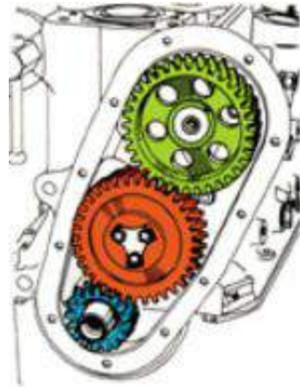
Los dientes de los piñones pueden ser rectos, éstos son ruidosos y de corta duración o en ángulo helicoidales bañados en aceite en un cárter o tapa de distribución, siendo éstos de una mayor duración. En el caso de dos ruedas dentadas, el cigüeñal y el árbol de levas giran en sentido contrario y, si son tres, giran el cigüeñal y árbol de levas en el mismo sentido.
