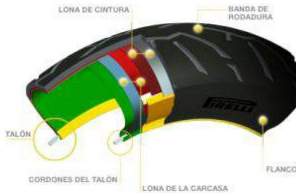
Partes de un neumático
