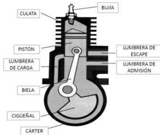
Las culatas para motores de dos tiempos no llevan elementos de distribución, siendo aún más sencillas si la refrigeración es por aire.
