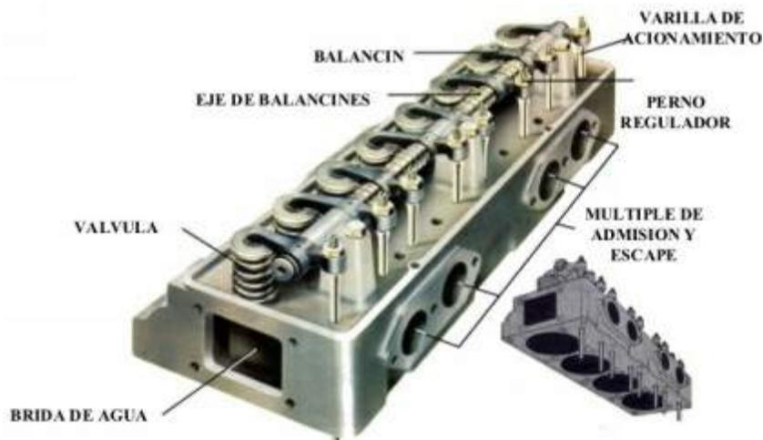
Es la pieza que va montada en la parte superior del bloque, que hace de tapa y cierra a los cilindros, formando la cámara de combustión.
