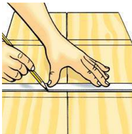
Figura 5 Empalme los lados con las marcas de ubicación de los estantes en los bordes exteriores. Use una regla para extender las marcas de los estantes a lo largo del trabajo.
