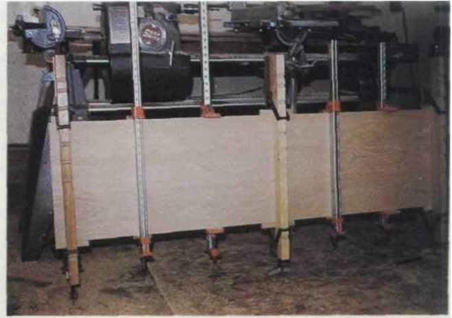
5 Las abrazaderas alternas ayudan a mantener el nivel superior pegado mientras se seca.
