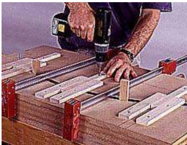
3 Utilice espaciadores de 3/4 de pulgada de espesor entre las piezas de forma de flexión. Sujete las piezas del encofrado y fije las tiras de alineación.
