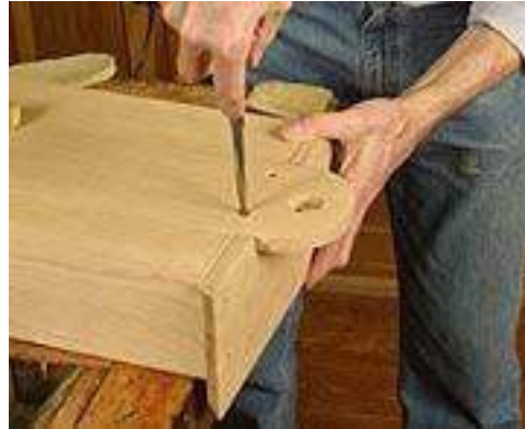
La parte posterior se atornilla solo cerca del centro. Luego, los bordes se clavan en su lugar, lo que permite el movimiento estacional.
