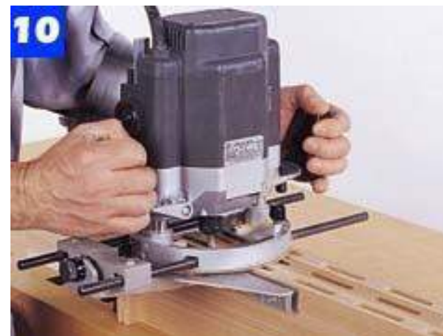
Para cortar la fila larga de mortajas en cada montante y riel, sujete tres de las piezas de trabajo juntas para sostener el enrutador.
