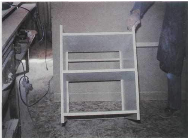
2 La sección de cajones ensamblada con estantes en su lugar. El marco de la cara ya ha sido pegado.
