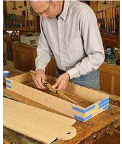
El falso techo y el falso fondo simplemente se unen a tope y se pegan a los lados. La parte superior e inferior reales reforzarán esta unión. Antes de que se seque el pegamento, verifique que la caja esté nivelada y cuadrada.
