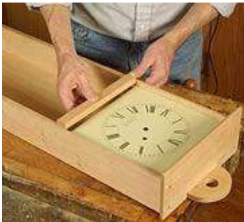
El divisor horizontal está dimensionado para actuar como un tope para ambas
