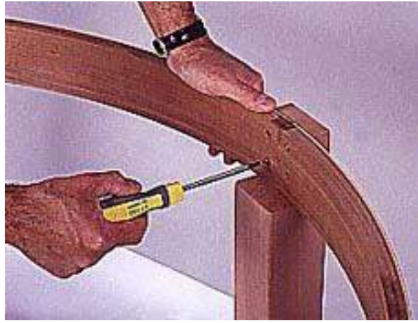
10 Coloque el delantal de modo que cada una de sus articulaciones quede centrada en una pierna. Use cuatro tornillos en cada junta para sujetar el delantal a las patas.
