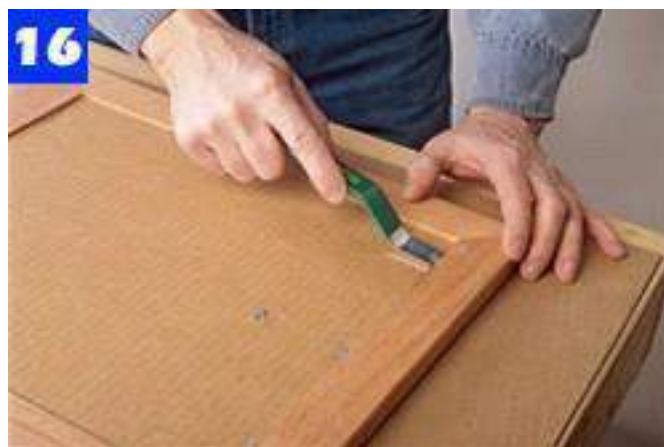
Con el marco boca abajo, instale el panel de vidrio. Luego, coloque la obra de arte montada en el marco.
