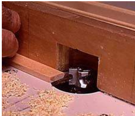
14 --Utilice un enrutador con una broca guía para ranurar para cortar las ranuras en los marcos superiores de las puertas para las tiras de retención de vidrio de plástico.
