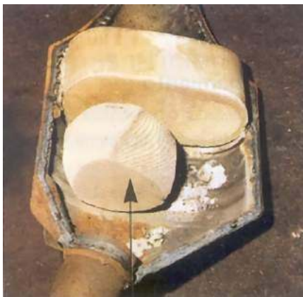
Fig. 4-11 Desgaste y rotura del catalizador
