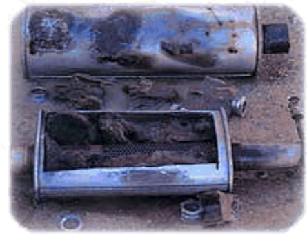
Fig. 4-10 Fusión del interior del catalizador
