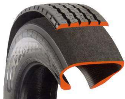
Fig. 8-17 Aplicación de una nueva banda
