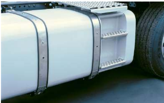
Fig. 1-4 Depósito y escaleras
