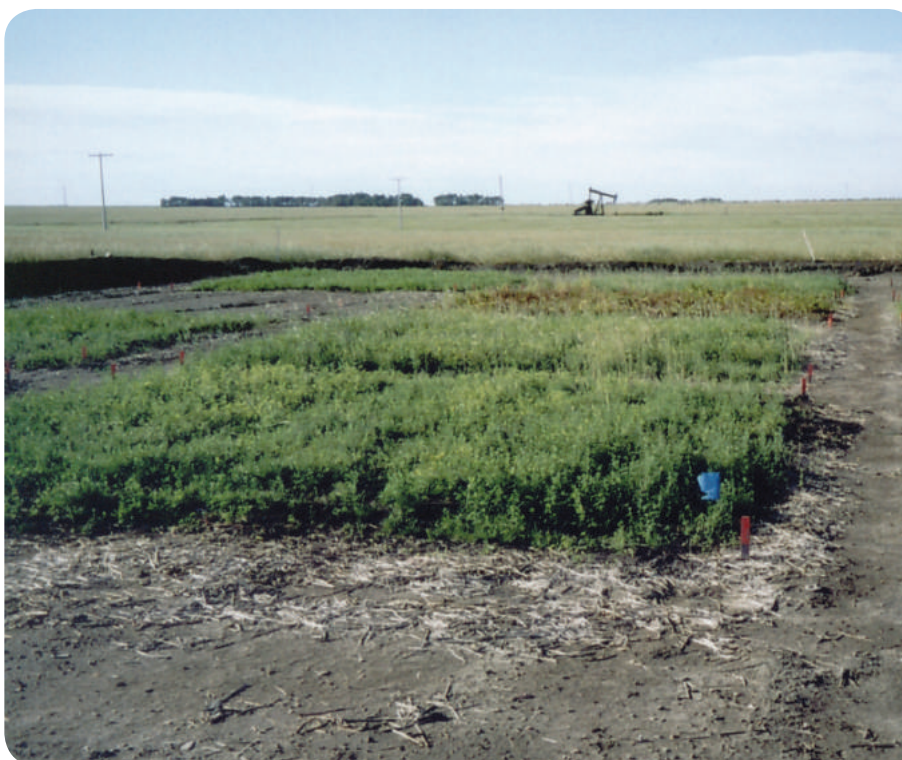
Figura 13.8. Experimento de biorremediação de solo contaminado com petróleo em Saskatchewan, Canadá, com destaque para plantas leguminosas e gramíneas sobreviventes. FONTE: Foto de Alexandre Verzani Nogueira – (arquivo pessoal - Alasca, EUA, junho de 2001).
