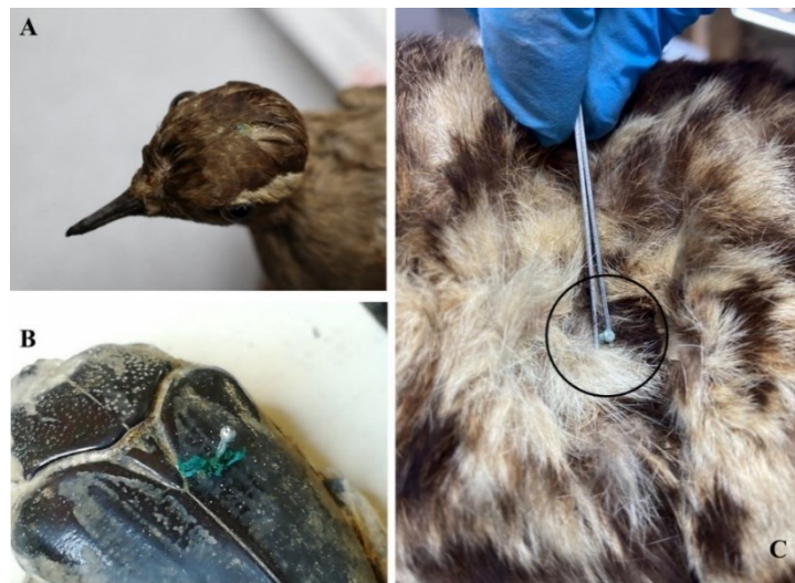
Figura 91 | Oxidação – Verdigris em elemento meálico (A) Presente na armadura composta por cobre exposta por perfuração na zona da cabeça do espécime; (B) Espécime de entomologia com alfinete com oxidação Verdigris. (C) Elemento metálico adicional com oxidação de Verdigris. Mariana Costa©, 2022
