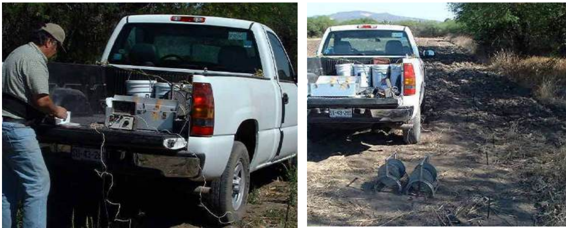
Fig 2.22. Resistímetro, cables electrodos y tendidos
