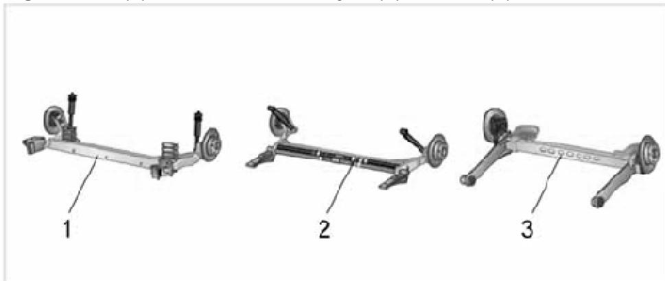
*Três tipos de eixos traseiros com rodas semi-independentes*
