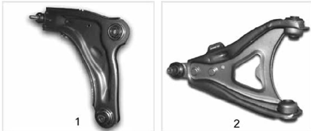
A disposição de todo o conjunto (o comprimento, a posição e o ângulo de articulação dos seus elementos) condiciona a trajetória das rodas quando o automóvel se desloca sobre um pavimento de superfície irregular. O comportamento das rodas, por sua vez, influencia o comando da direção, a aderência à faixa de rodagem e o desgaste dos pneus.
