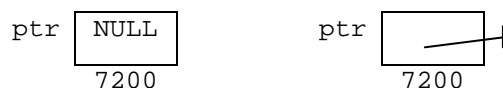
Figura 5.3. Dos representaciones distintas de la variable ptr de tipo puntero a entero
