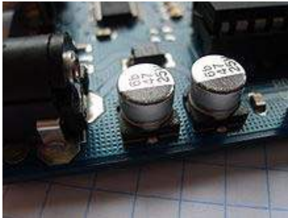
Condensadores electrolíticos de aluminio en tecnología SMD (montaje superficial)
