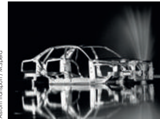
奥迪空间框架结构（ASF）大量使用金属铝，使得它比同类钢结构轻大约40%。
