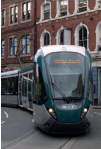
诺丁汉的Net Citadis 302电车由阿尔斯通（Alstom）公司在2014年建成，拥有全铝制车身。
