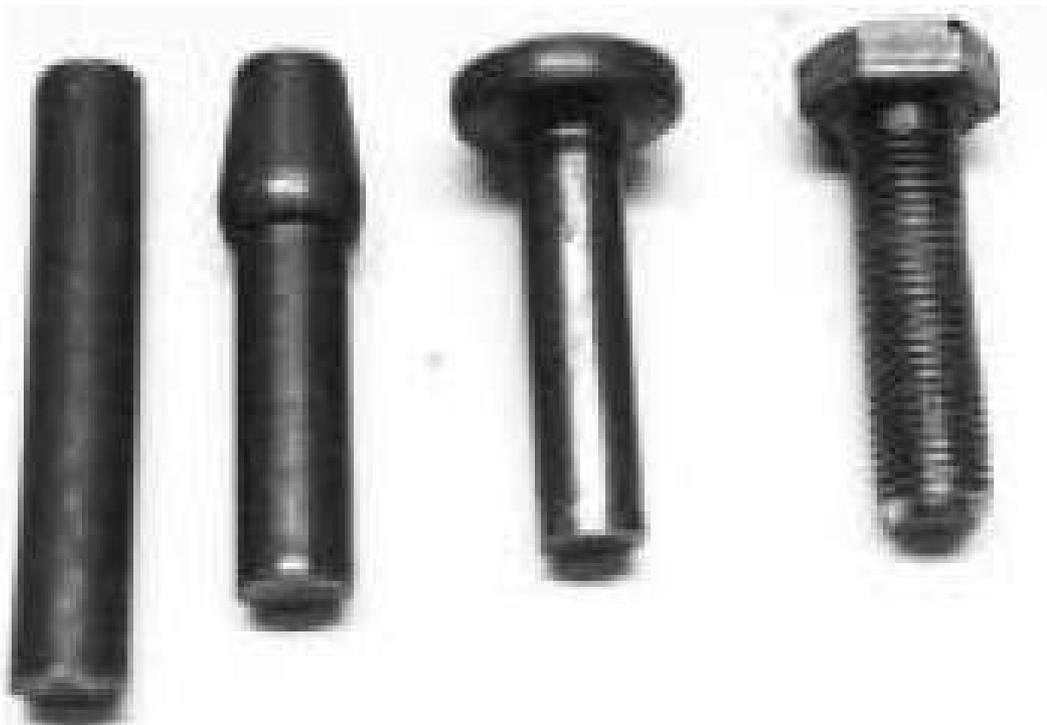
Seqüência de passes de recalque para obtenção de parafuso sextavado de rosca métrica M9. Da esquerda para a direita: etapa 1 (tarugo), etapa 2 (recalque da cabeça), etapa 3 (recalque da cabeça) e etapa 4 (corte).
