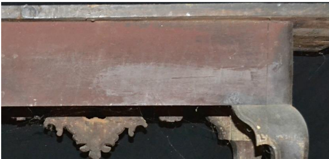
Fig. 22 – Oxidação do estrato de acabamento: Verso da mesa B. Fonte: de elaboração própria.
