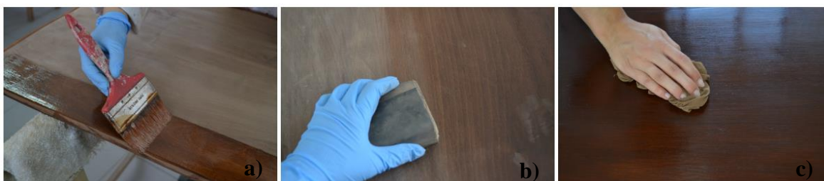
Fig. 79 – Tratamento superficial dos tampos: a) aplicação de camadas de goma-laca; b) polimento com folha abrasiva; c) polimento com pano de nylon. Fonte: de elaboração própria.
