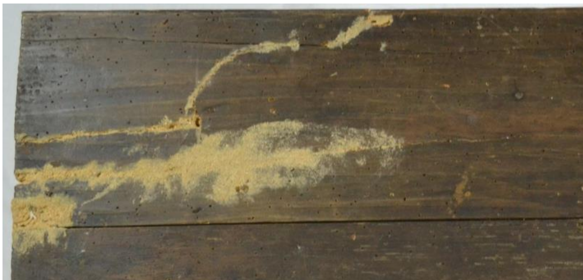
Fig. 12 – Colagem de fraturas, fendas e preenchimento de lacunas no tampo da mesa A. Fonte: de elaboração própria.
