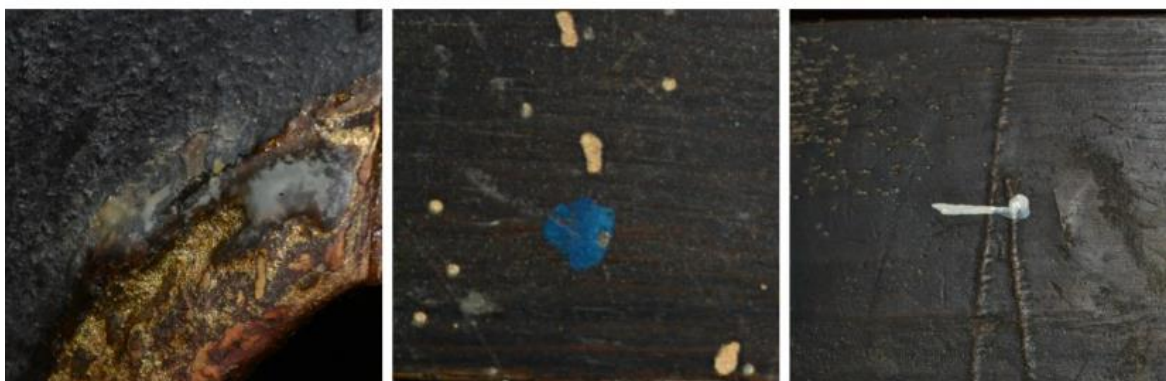
Fig. 23 – Exemplos de danos por negligência: cera de vela; tinta azul e tinta branca, respetivamente (Lado direito da face anterior da mesa A – 1ª imagem; e tampo da mesa B – 2ª e 3ª imagens). Fonte: de elaboração própria.
