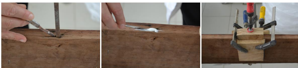
Fig. 66 – Colagem de fendas com levantamento de fibras. Fonte: de elaboração própria.
