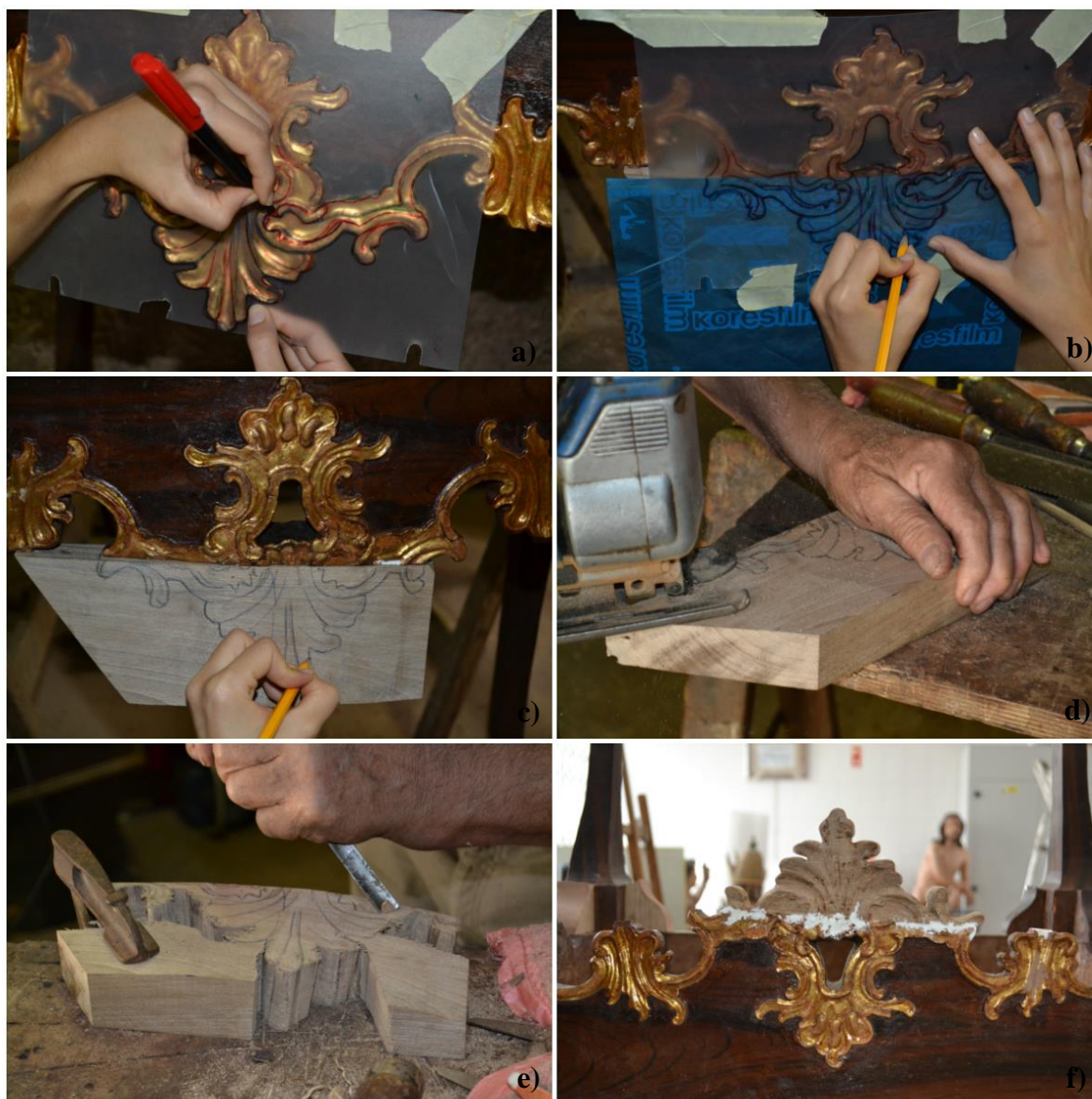
Fig. 71 – Reprodução do remate do ornamento central da mesa A: a) desenho do motivo a entalhar; b) transferência do motivo para a madeira; c) marcação do desenho sobre a madeira; d) entalhe grosseiro – recorte com tico-tico; e) entalhe fino com recurso a goiva; f) motivo finalizado e aplicado no avental frontal da mesa. Fonte: de elaboração própria.
