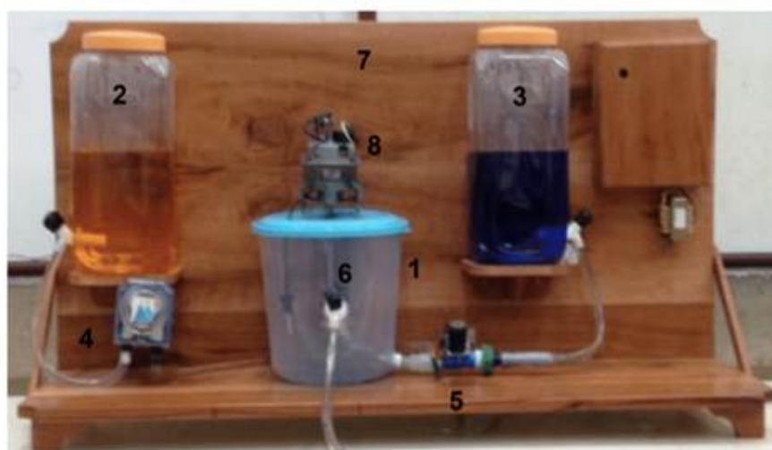
Figura 1. Módulo de reator CSTR construído com baixo custo em operação.
