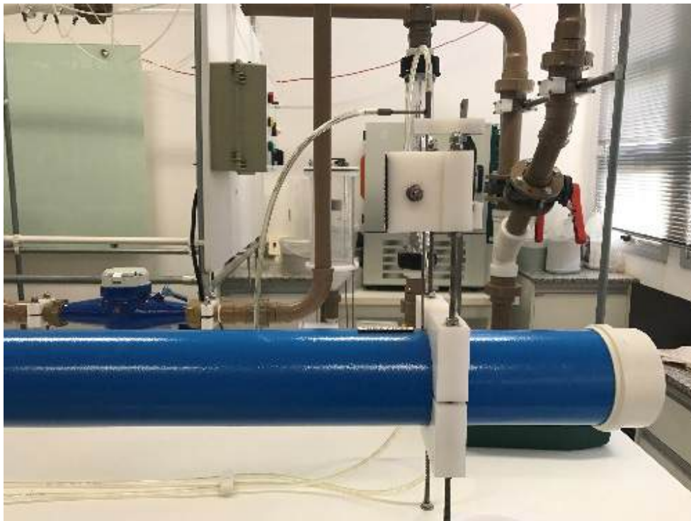
Figura 1 – Tubo de Pitot instalado
