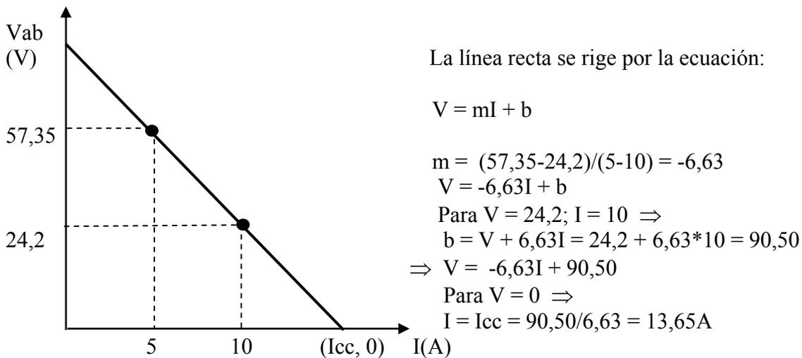
Figura 2.58 Problema 2.29 Gráfica de Voltaje vs Corriente
