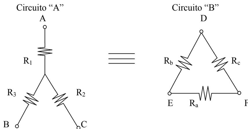
Figura 2.8 Circuitos equivalentes Estrella - Delta.
