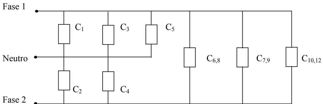
Figura 5.13 Diagrama de conexión de las cargas. Problema 5.9
