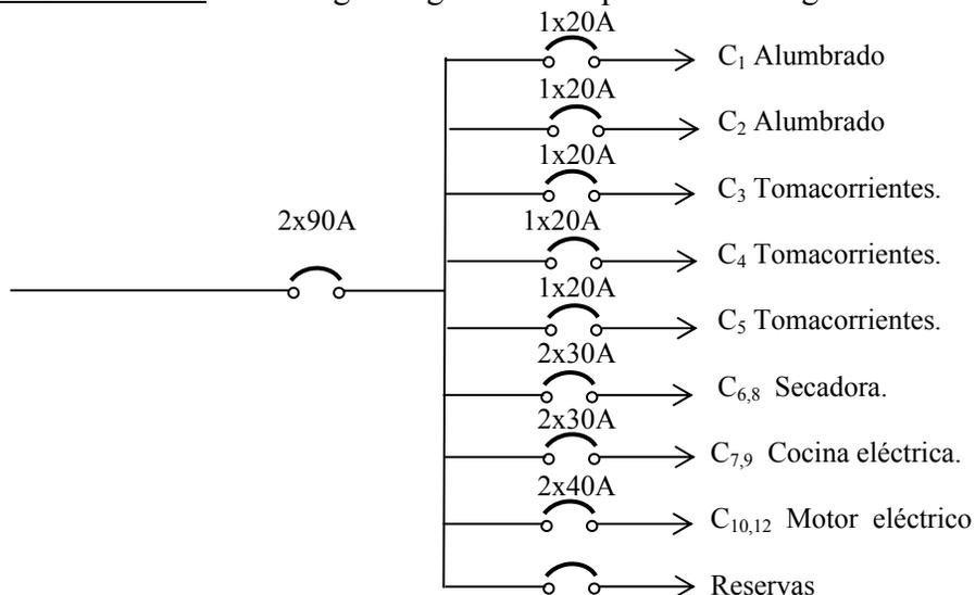
Figura 5.14 Diagrama unifilar del Tablero.
