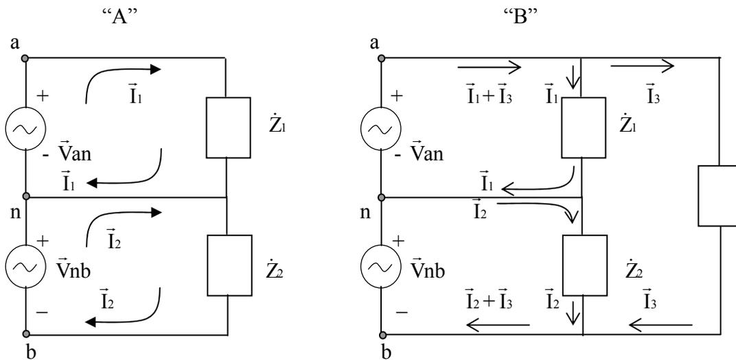
Figura 3.30 Circuito monofásico “A” y circuito monofásico trifilar “B”.
