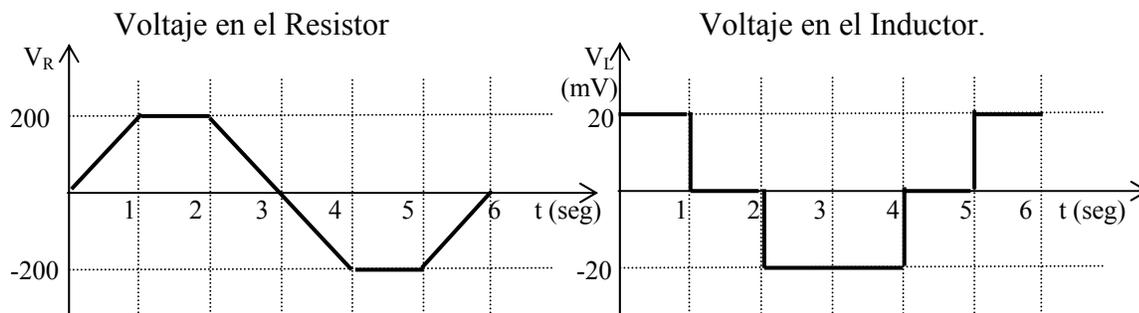
Figura 1.48 Problema 1.74 Voltajes en el Resistor e Inductor.
