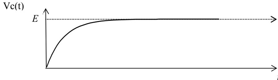
Figura 2.47 Problema 2.22. Gráfica del voltaje en un Capacitor en carga
