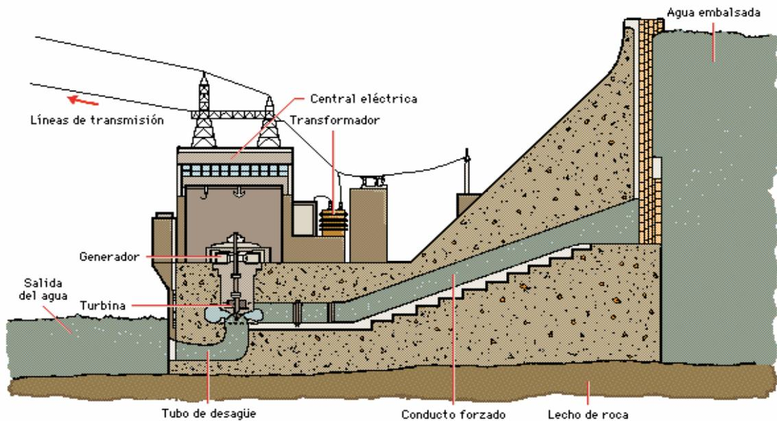
Figura 1.7 Problema 1.7 Sección transversal de una Central Hidroeléctrica
