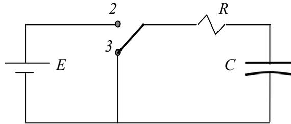
Figura 2.49 Problema 2.23 Circuito RC en descarga
