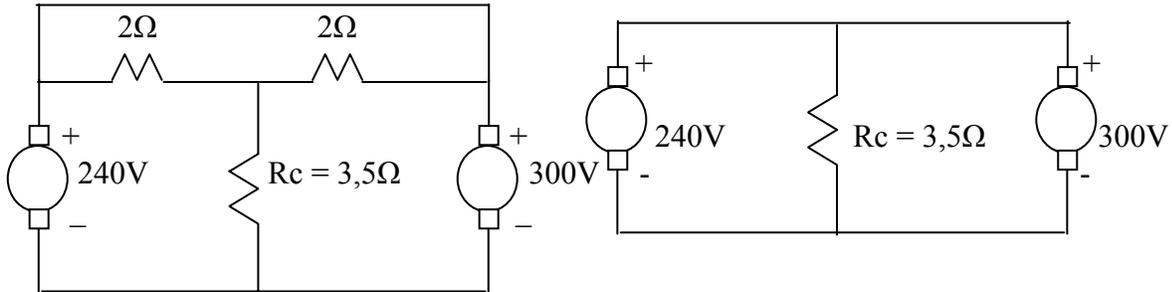
Figura 2.30 Circuitos equivalentes del Problema 2.11. Cálculo de  $I_n$
