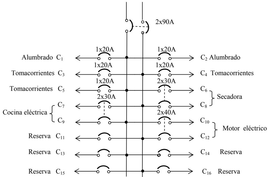
Figura 5.15 Diagrama del Tablero.
