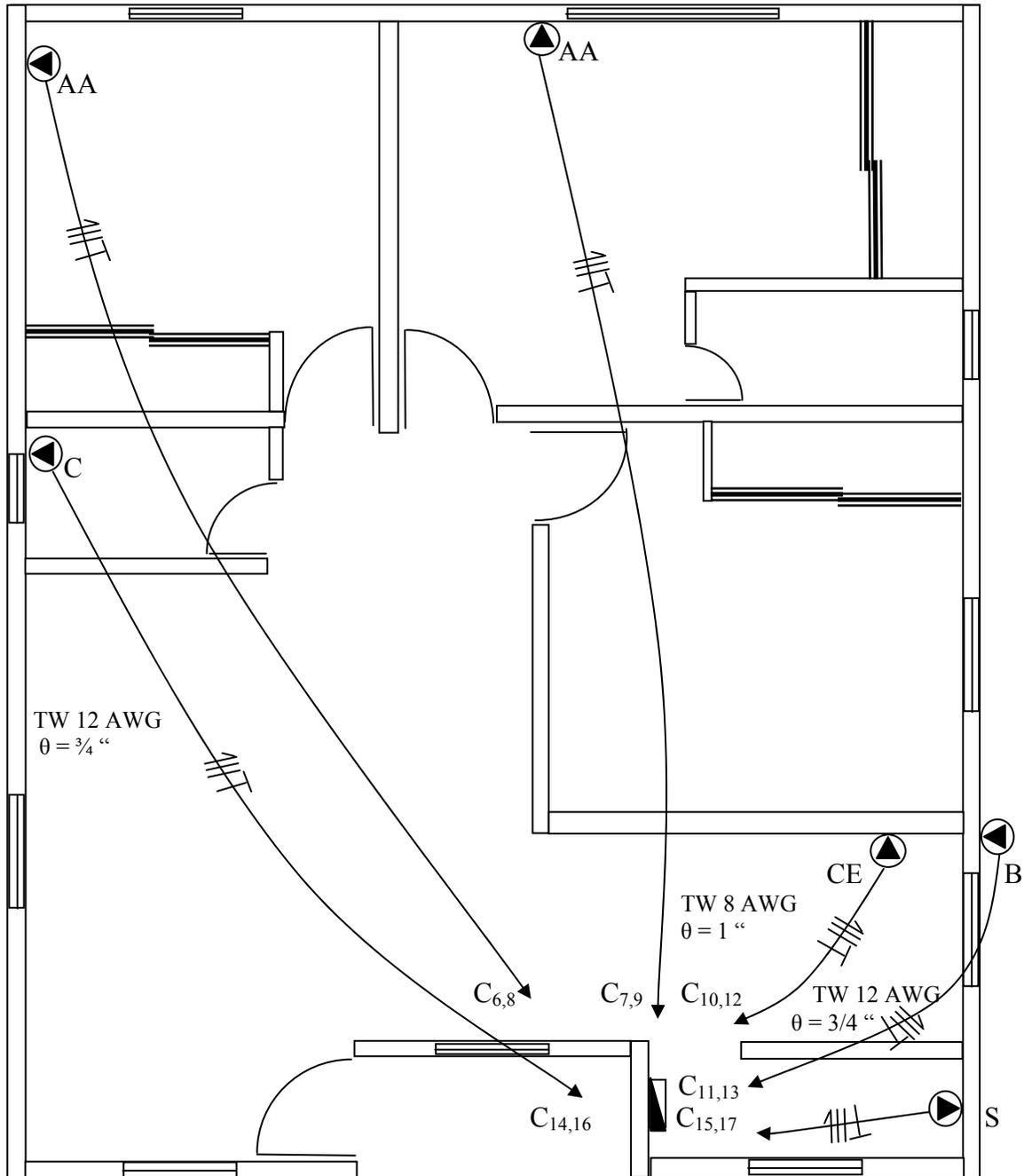
Figura 5.3 Circuitos de Tomacorrientes Especiales.
