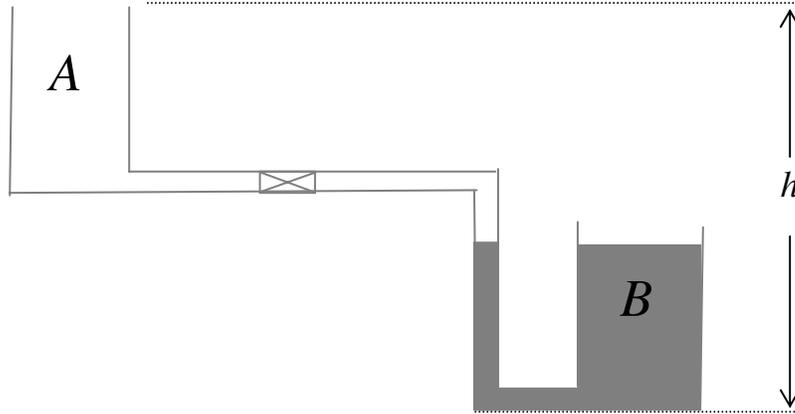
Figura 1.5 Diferencia de altura o nivel entre los recipientes A y B.
