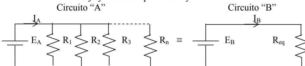
Figura 2.7 Problema 2.4. Circuitos equivalentes paralelos.
