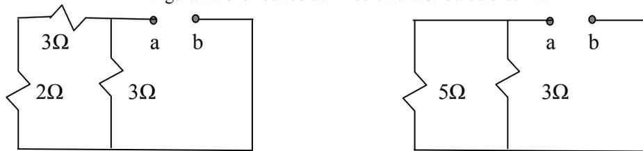
Figura 2.19 Circuitos equivalentes del Problema 2.8. Cálculo de Rth
