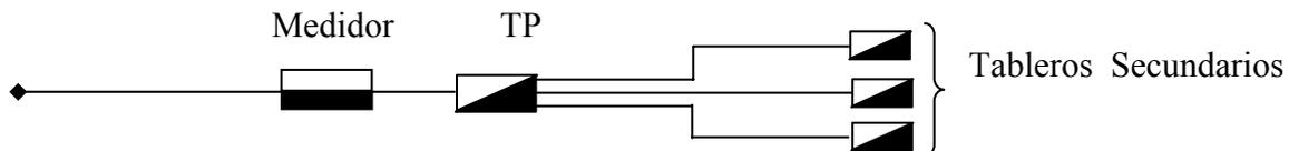
Figura 5.11 Diagrama de Medidor, Tablero Principal y Tableros Secundarios.
