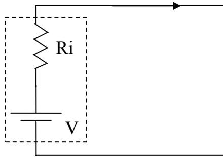
Figura 1.11 Fuente de Voltaje Real.
