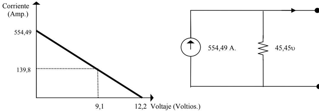
Figura 1.16 Problema 1.8 Gráfica de Voltaje vs Corriente de una Fuente Real de Voltaje
