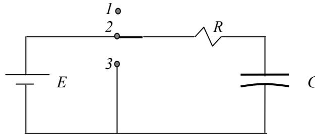
Figura 2.48 Problema 2.23 Circuito RC en descarga
