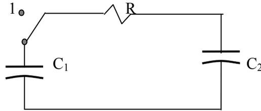
Figura 2.170 Problema 2.72 Circuito RC en descarga.
