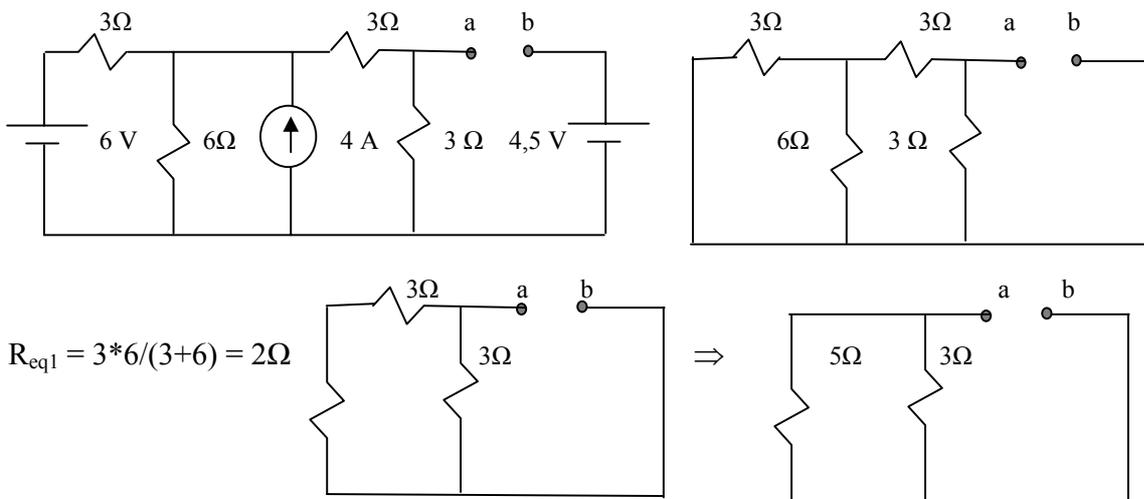
Figura 2.26 Circuitos equivalentes del Problema 2.10. Cálculo de  $R_n$
