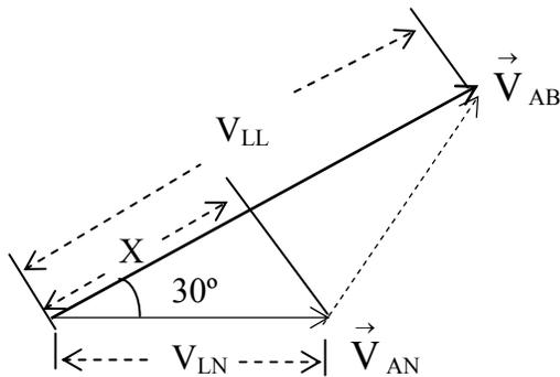
Figura 4.2 Problema 4.1 Cálculo del Voltaje Línea – Línea.
