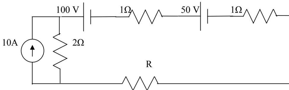
Figura 2.183 Problema 2.87 Teorema de Máxima Transferencia de Potencia.
