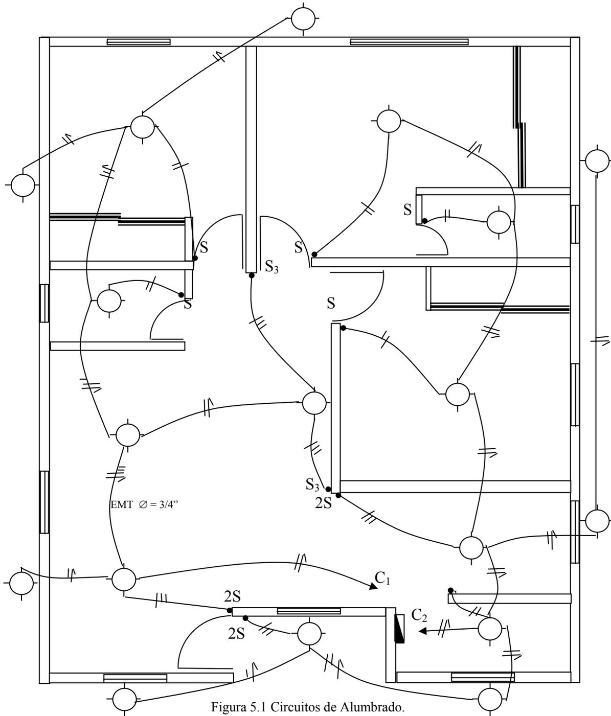
Figura 5.1 Circuitos de Alumbrado.
