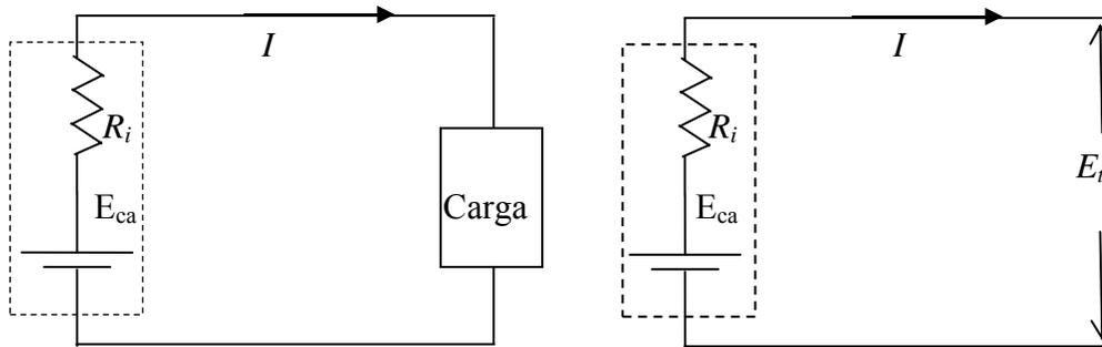
Figura 1.14 Circuito de Fuente Real de Voltaje.
