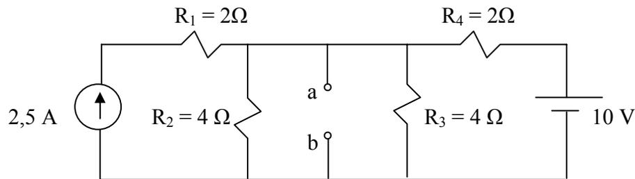
Figura 2.12 Problema 2.7. Circuito para aplicar el Teorema de Superposición.
