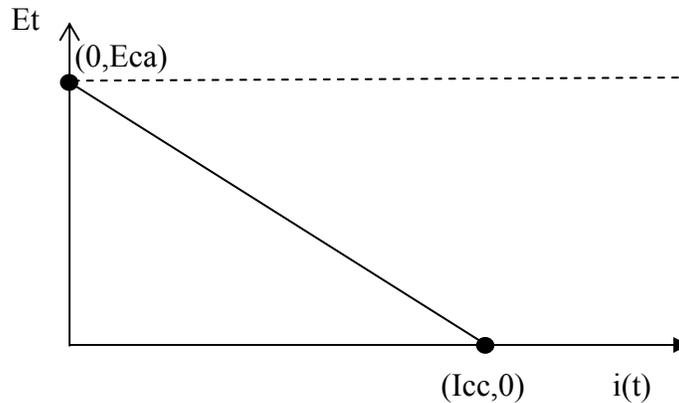
Figura 1.15 Gráfica de Voltaje vs Corriente de una Fuente Real de Voltaje
