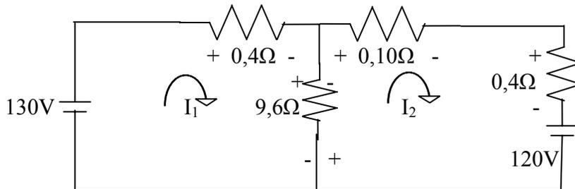
Figura 2.126 Problema 2.53 Método de Mallas Circuito equivalente.
