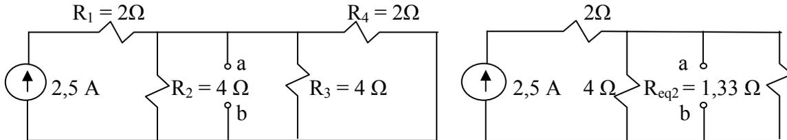
Figura 2.15 Problema 2.7. Circuitos eliminando la fuente de voltaje.
