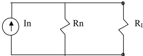
Figura 2.24 Circuito equivalente de Norton.
