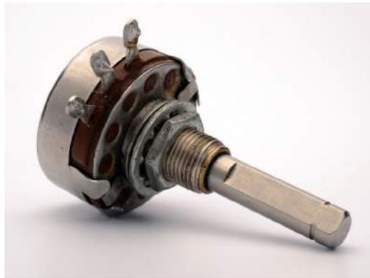
Figura 31 - Modelo de resistor de valor variável
