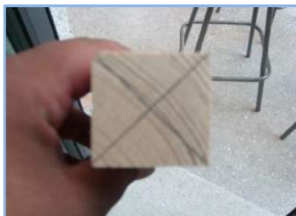
Fig. 24 Trazo en el centro de la pieza.
