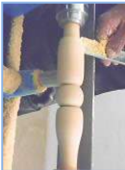
Figs. 78, 79 y 80 Nivelación final con cuchilla de filo oblicuo.
