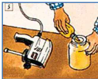
Fig. 16 Aplicación de aceite de vaselina para mantener lubricado el mecanismo de la pistola.
