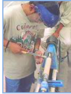
Figs. 65, 66 y 67 Ranurado con fresa partidora.
