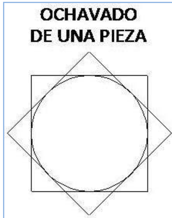
Fig. 7 Ochavado de una pieza.
