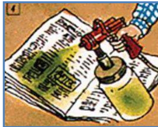
Fig. 15 Limpieza de recipientes y tubos de la pistola.
