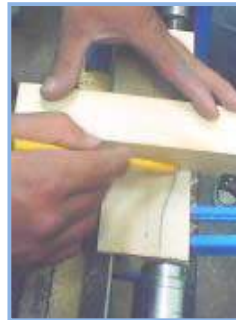
Figs. 60, 61 y 62 Transferencia del trabajo a las plantillas.
