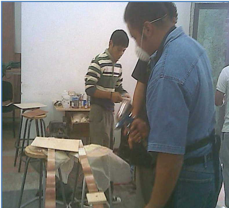
Fig. 39 Aplicación de primer y laca a color.
