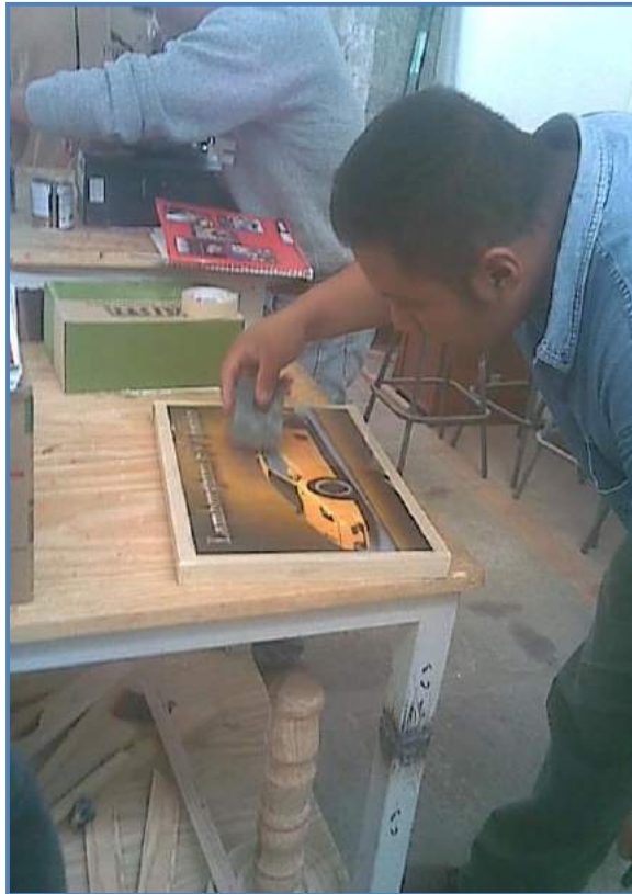
Fig. 46 Aplicación de resina epóxica.
