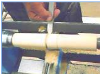
Figs. 71 y 72 Redondeo de hombros con cuchilla de filo oblicuo.
