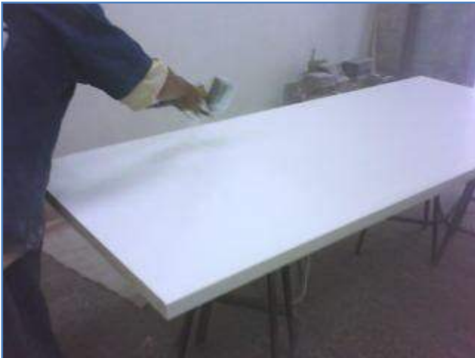
Fig. 42 Aplicación de primer y esmalte.
