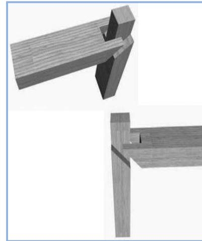
Fig. 12 Ensamble de quijera con inglete, se diseña en el caso que las caras del marco estén a la vista.
