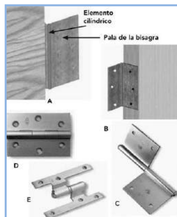
Fig. 15 Diferentes dispositivos de giro aplicable a puertas y ventanas, bisagra pomel A y B, de clavija C, bisagra corriente con pasador incorporado D y bisagra en H, con pasador menor que las palas, que permite que quede un mayor distanciamiento entre el marco y la hoja de la puerta.
