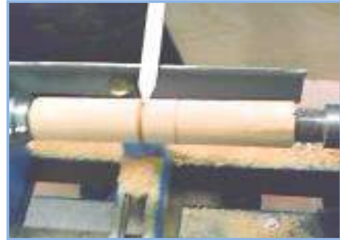
Figs. 73 y 74 Trazo y corte oblicuo.
