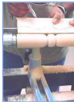
Figs. 68, 69 y 70 Giro a mano para rectificación de claro.
