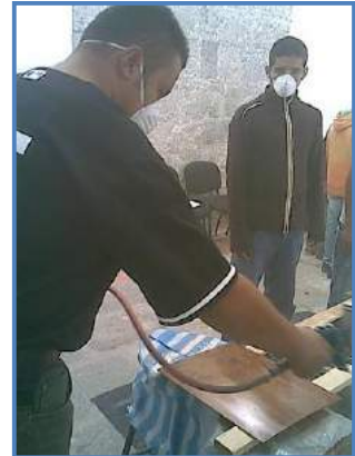
Fig. 37 Aplicación de laca brillante base nitrocelulosa.
