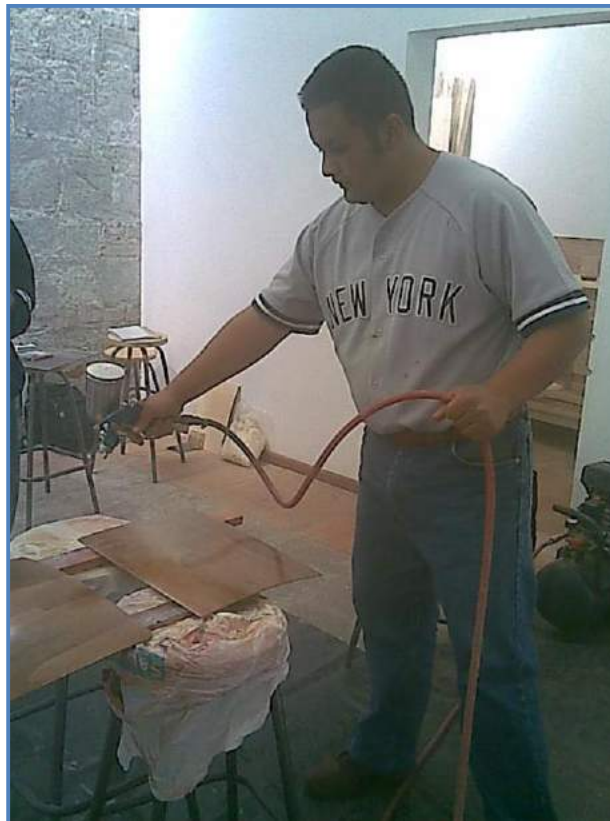
Fig. 44 Aplicación de tinta al alcohol con poliuretano.
