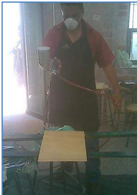
Fig. 45 Aplicación de tinta al alcohol con poliéster.
