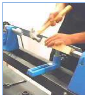
Figs. 34 y 35 Colocación y fijado de la pieza.
