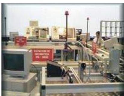
En el INET contamos con un laboratorio de procesos de producción integrados: el Centro de Integración de Manufacturas (CIM) que, si bien tiene sólo fines didácticos, puede producir en forma real y controlada por computadoras distintos elementos, permitiendo simular el trabajo en diversos aspectos de los procesos productivos: control automático de procesos, control de calidad en línea de fabricación y gestión de la producción.
