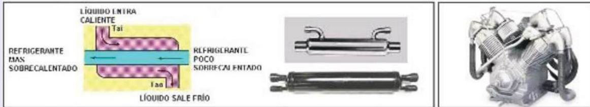
Fig 32. Intercambiadores de calor Compresor de dos etapas
