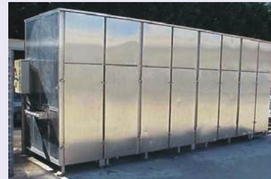
Fig 27. Túnel de enfriamiento
