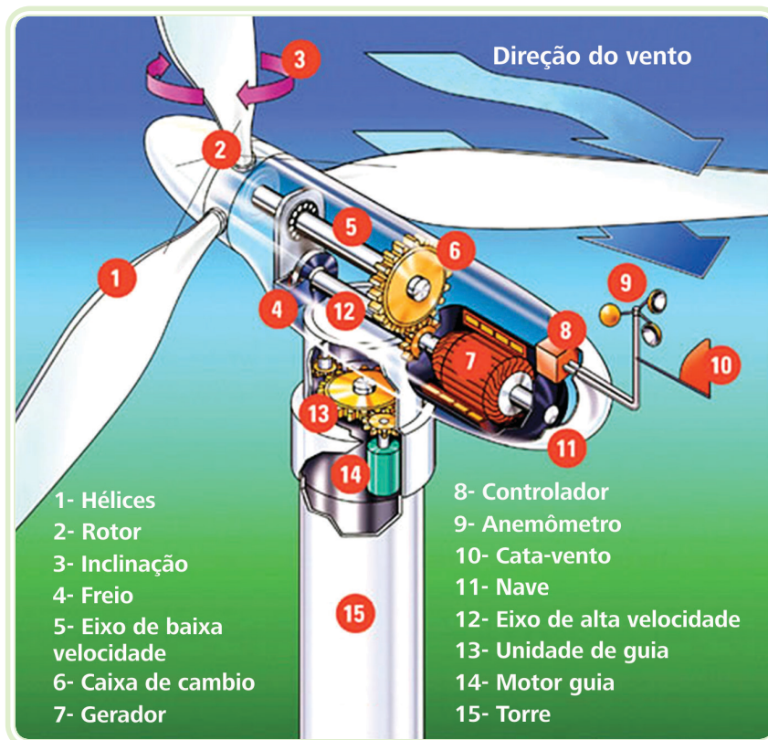
Figura 6.1: Partes que compõem uma turbina eólica
