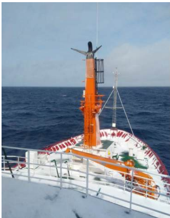
FIGURA 5: Torre micrometeorológica de fluxos empregada pelo INPE no Oceano Austral em novembro de 2018 a bordo do Navio Polar Almirante Maximiano . Essa torre, semelhante à utilizada por Pezzi et al. (2016) e Hackerott et al. (2018), mantém instrumentos meteorológicos que estimam os fluxos de calor, momentum e gases entre o oceano e a atmosfera através da técnica da Covariância de Vórtices. Fonte: Programa INTERCONF/INCT da Criosfera.
