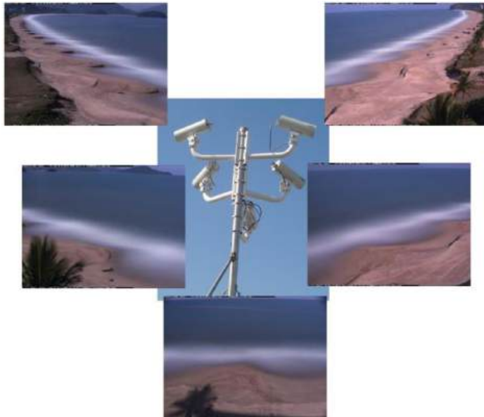
FIGURA 3: Sistema de videoimageamento Argus na praia de Massaguaçu (SP). Fonte: Laboratório de Dinâmica Costeira/IOUSP).
