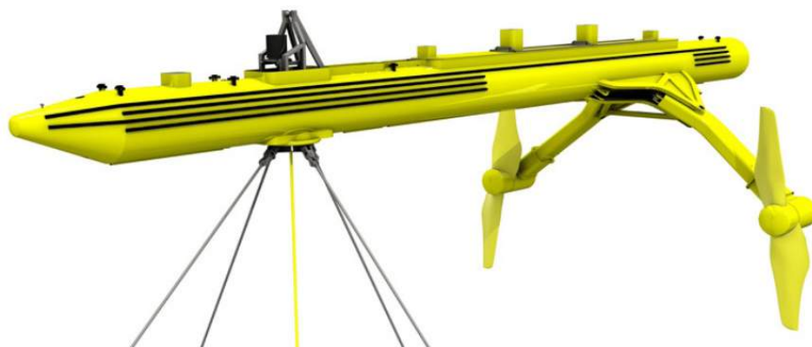
FIGURA 7: Gerador de corrente de maré SR2000. Fonte: www.orbitalmarine.com
