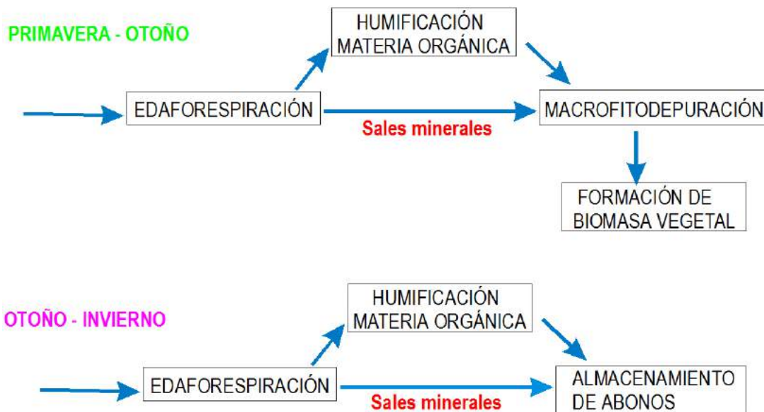
Figura 4. Esquema de un filtro verde y de su funcionamiento en diferentes situaciones climáticas.
