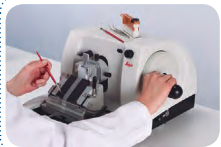
■ El microtomo de rotación puede hacer cortes de 1 a 25 μm de espesor.
