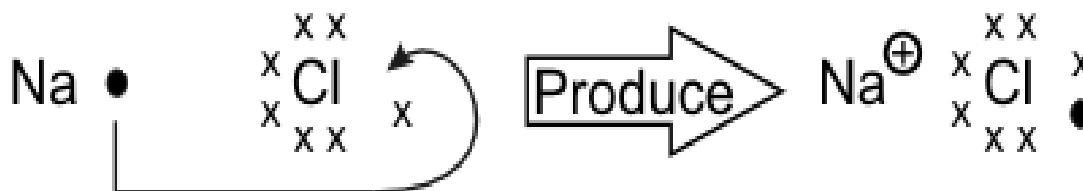
Fig. 2.2- Unión iónica : cloruro de sodio
