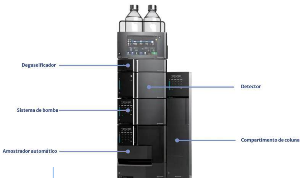
Figura 10. Componentes gerais de um HPLC.
